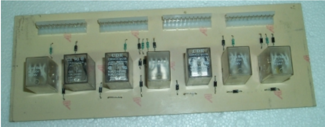
Fig. 4.21 VISTA DE LOS COMPONENTES DE LA TARJETA 3-4
