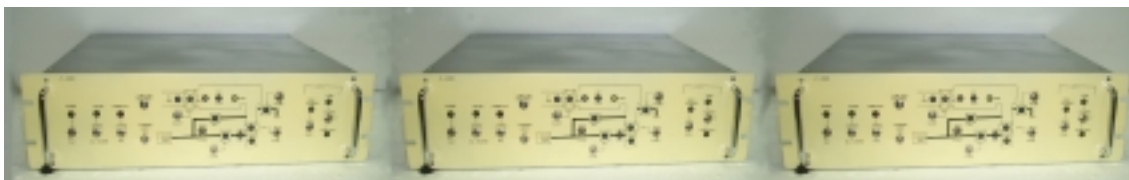
Fig. 5.3 MÓDULOS DE AUTOMATIZACIÓN PARA LAS VÁLVULAS ELECTRONEUMÁTICAS DE LA LÍNEA DE SALIDA DEL PELETRÓN QUE FUERON CONSTRUÍDOS
