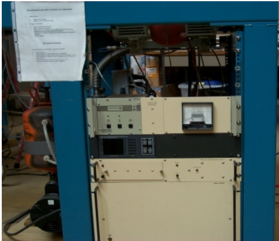
Fig. 4.4 MÓDULOS PARA LA BOMBA TURBO-MOLECULAR Y LOS SENSORES
