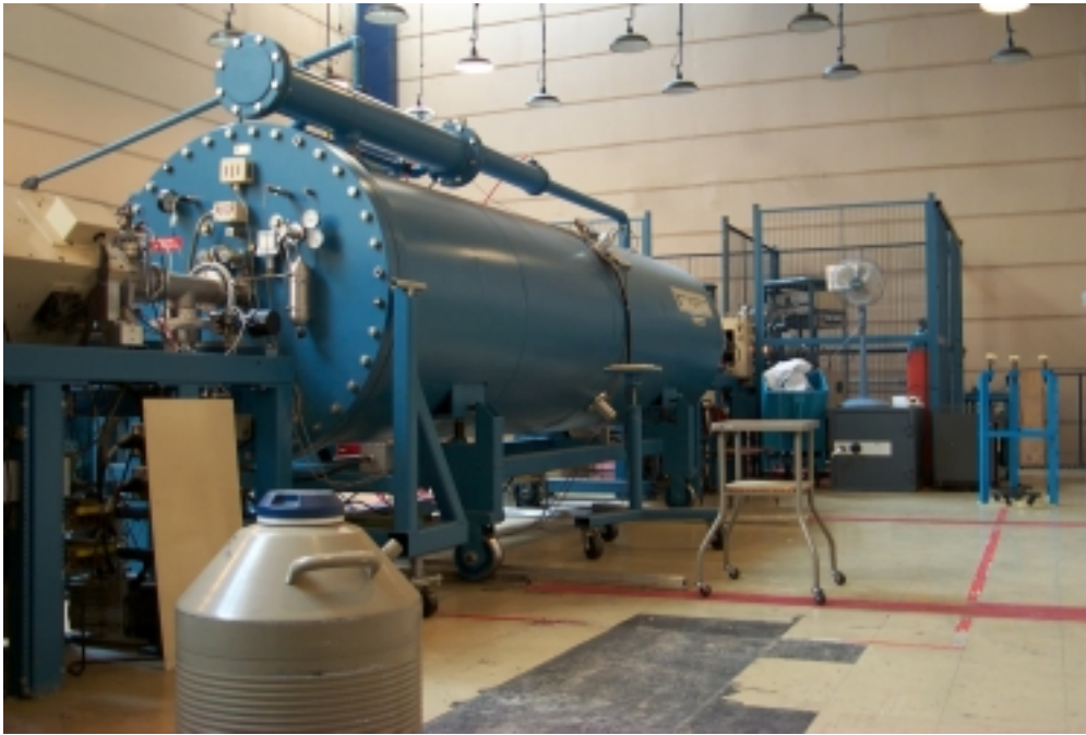
Fig. 4.9 TANQUE DEL PELETRÓN
