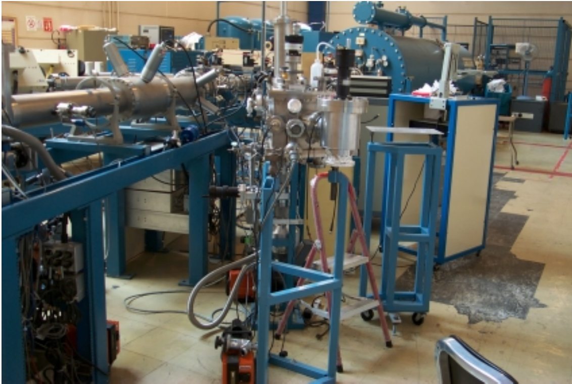
Fig. 5.1 LÍNEA DE SALIDA DEL ACELERADOR DE PARTÍCULAS PELETRÓN DONDE SE INSTALARÁ EL MÓDULO DE AUTOMATIZACIÓN
