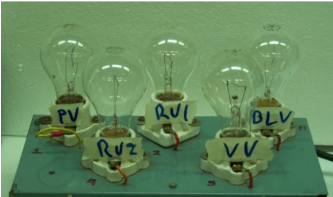
Fig. 4.1 FOCOS UTILIZADOS PARA LA SIMULACIÓN DE LAS VÁLVULAS
