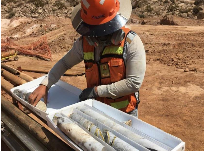
Figura 5.4 Logueo realizado para la cimentación de Jales Sur.
