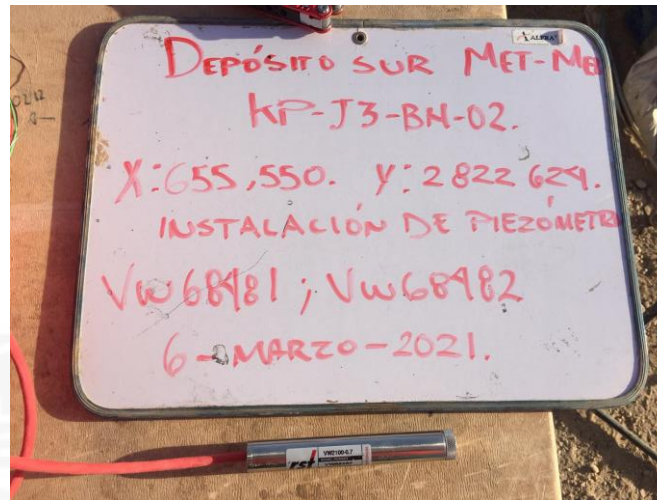
Figura 5.11 Datos y evidencia de piezómetro de cuerda vibrante antes de ser instalado.
