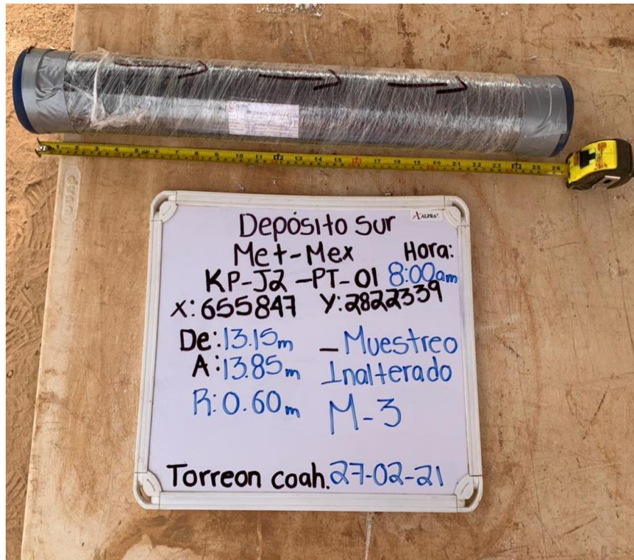
Figura 5.5 Shelby obtenido después del hincado en un sondeo para el proyecto Jales Sur.
