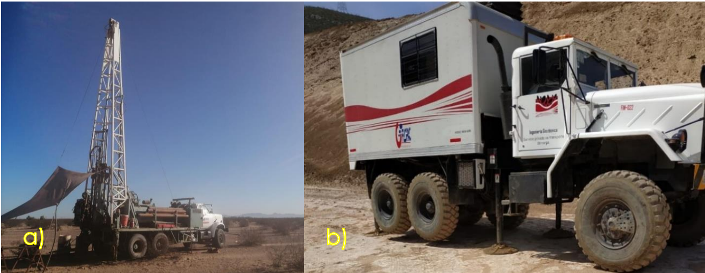
Figura 4.3 a) Máquina de perforación Mobile Drill. / b) Camión Hysson 200 kN para sondeos CPTu.
