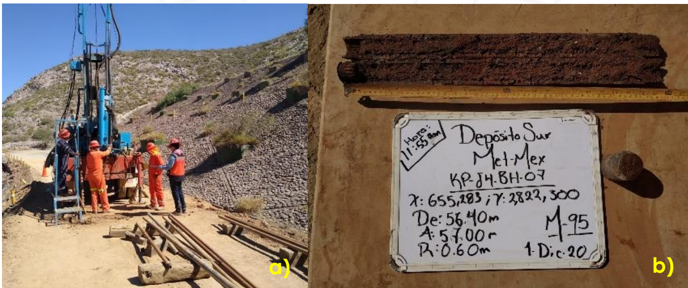
Figura 5.1 a) Conteo de golpes durante prueba SPT / b) Muestra de jal en tubo partido.
