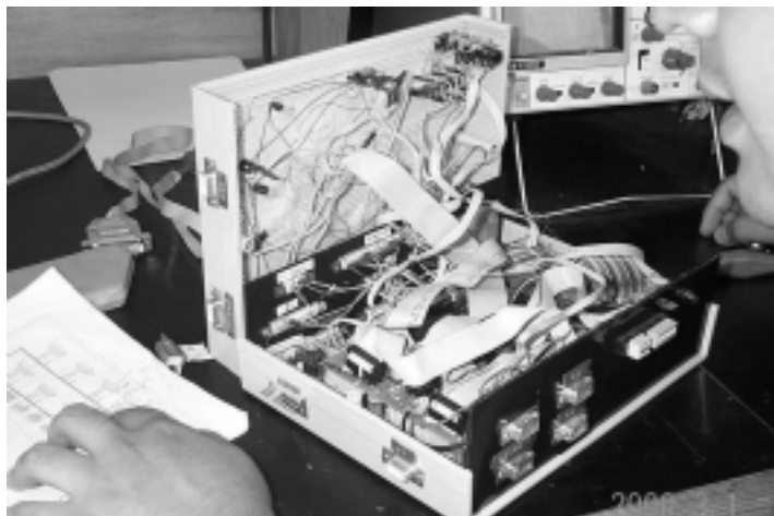
Figura 1.2. Imagen de la construcción del simulador del satélite (SIMSAT).
