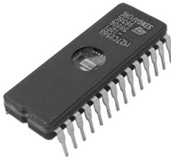
Figura 6.5. Memoria M27C256B -12F1 utilizada para almacenar SOFMIN
