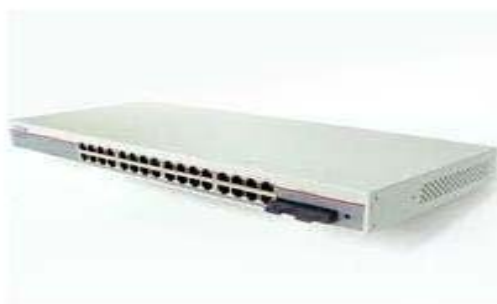
Fig. 3.3 Switch 10 / 100 MBPS de 32 puertos.
