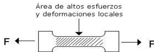
Figura 2.5 No homogeneidad en los esfuerzos en una muestra
