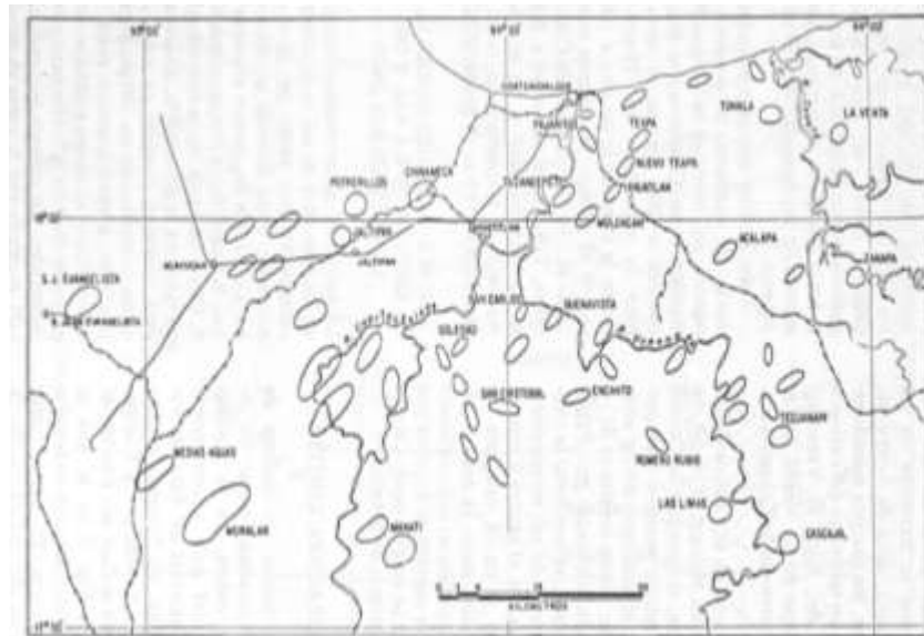
Figura 4.5.1. Estructuras salinas (domos) de la Cuenca Salina del Istmo. Imagen obtenida del Instituto Mexicano del Petróleo IMP.
