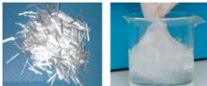
Figura 5.7.5. Fibras CemNET secas (izquierda) que forman una red de tipo manto cuando se mezclan con agua (derecha). Imagen obtenida de (Baggini Almagro, Frates, Garand, & Meyer, Sellado de fracturas: Avances en el control de las pérdidas de circulación).
