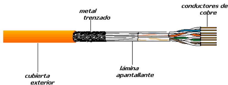
Figura 2.6 Cable SPT de cuatro pares.
