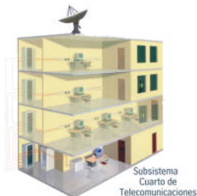
Figura 2.16 Subsistema de Cuarto de Telecomunicaciones
