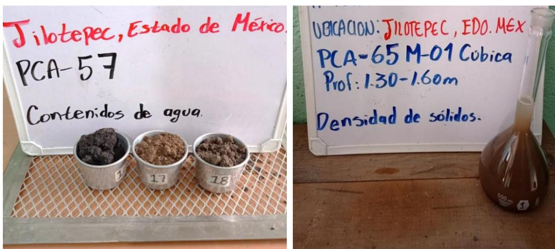
Figura 3.12. Obtención de: a) Contenido natural de agua, B) Peso específico relativo
