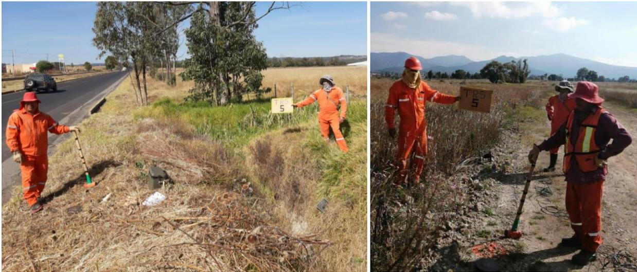
**Figura 3.21. Ejecución de un tendido de refracción sísmica.**
