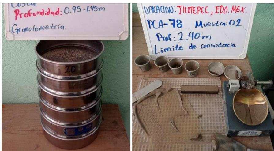
Figura 3.11. Obtención de: A) Granulometrías por mallas, B) Límites de consistencia.
