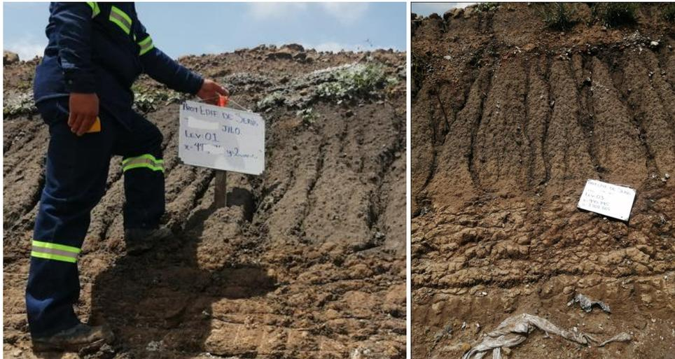
**Figura 3.6. Registro de la estratigrafía en cortes sobre el terreno.**
