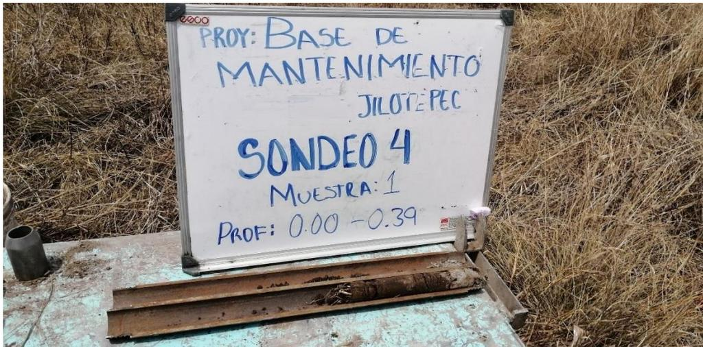
**Figura 3.8. Muestra recuperada con la herramienta de tubo partido.**
