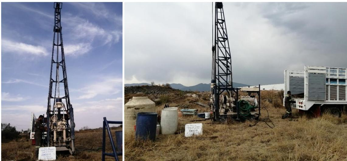
**Figura 3.7. Maquinaria para Sondeo Mixto**
