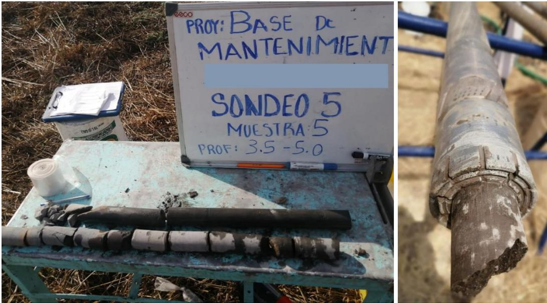
**Figura 3.9. Obtención de muestras en sondeo a rotación.**
