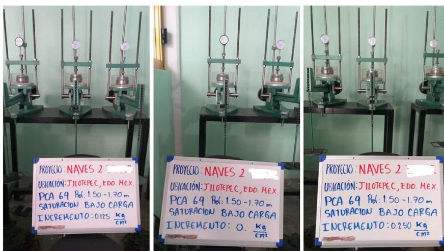
**Figura 3.14. Prueba de Saturación bajo carga**
