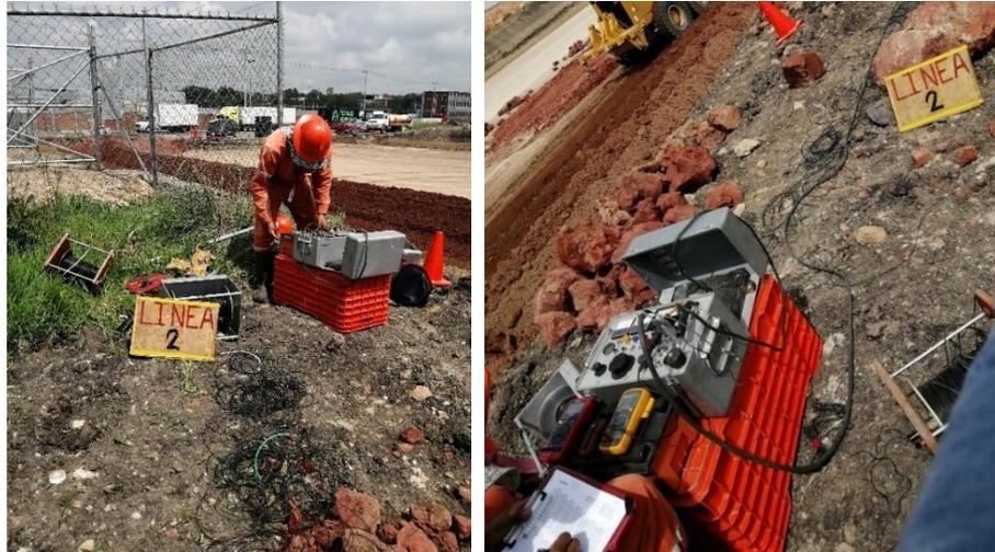
**Figura 3.18. Ejecución de un Tendido dipolo-dipolo.**
