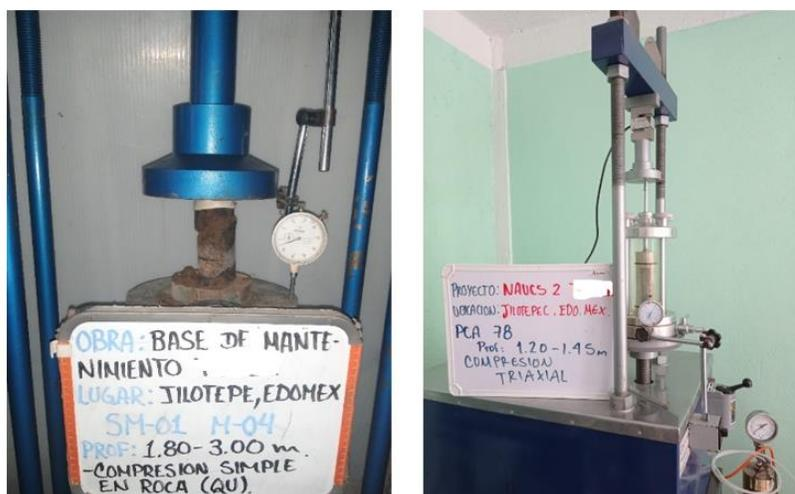
**Figura 3.13. Ejecución de pruebas de resistencia a: A) Compresión simple, B) Compresión triaxial**
