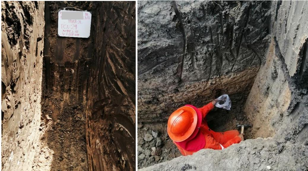
***Figura 3.3. Registro de pozos a cielo abierto y recuperación de muestras alteradas.***
