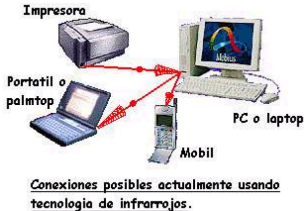
Figura 1.3 Conexiones Por Infrarrojo
