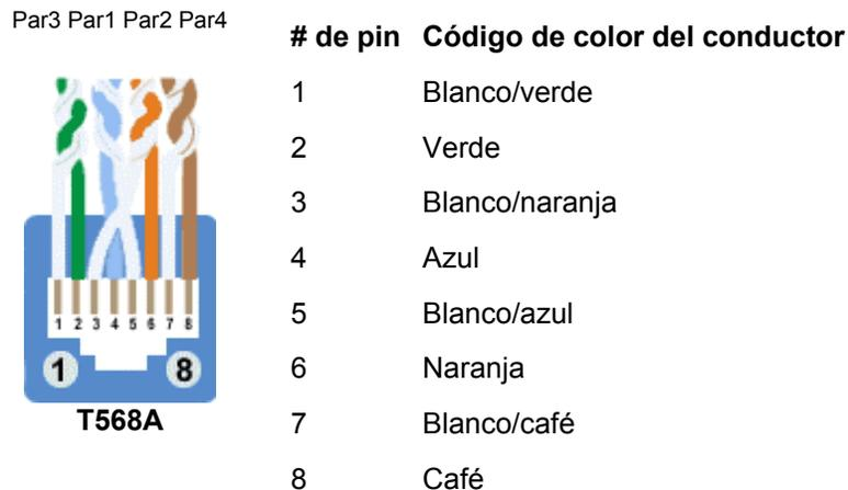
**Figura 2-7.** Asignación de pares en jack modular de ocho posiciones para UTP.
