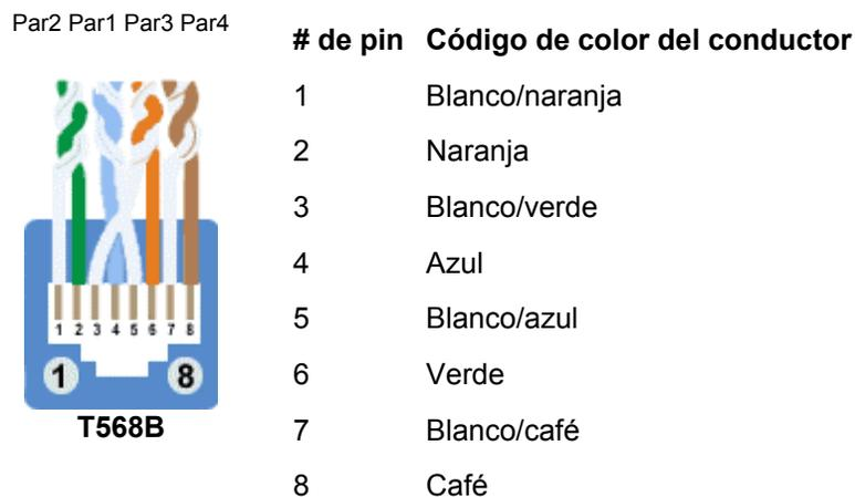
**Figura 2-8.** Asignación de pares en jack modular de ocho posiciones para UTP.
