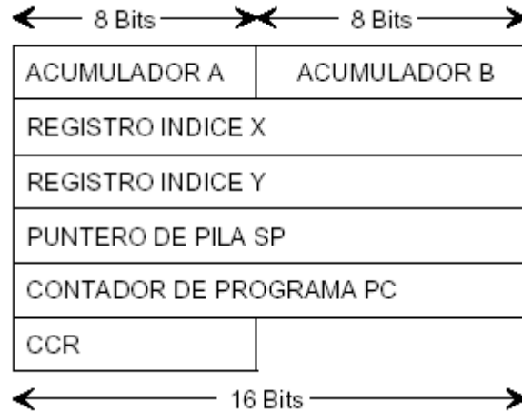
Figura 4.5 registros de microcontrolador MC68HC11F1
