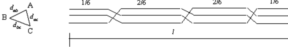
Figura 2.3 Transposición de conductores de una línea eléctrica.
