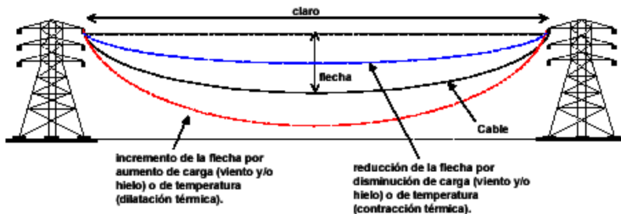
Figura 4.7 Cambios en la flecha del conductor.
