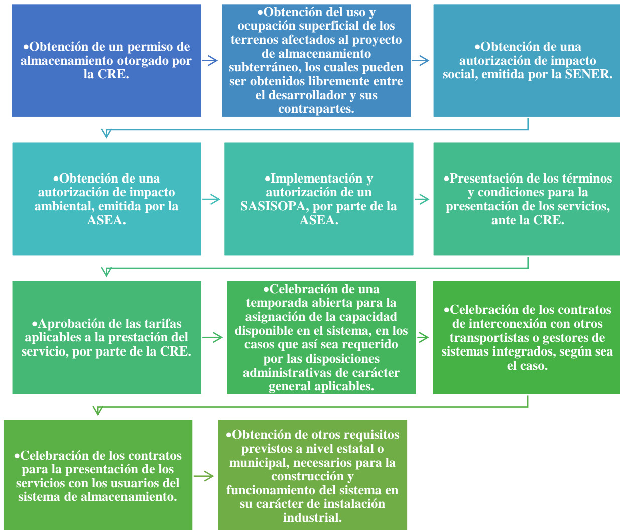
Figura 93. Requisitos previstos en la legislación vigente para el almacenamiento subterráneo de gas.
