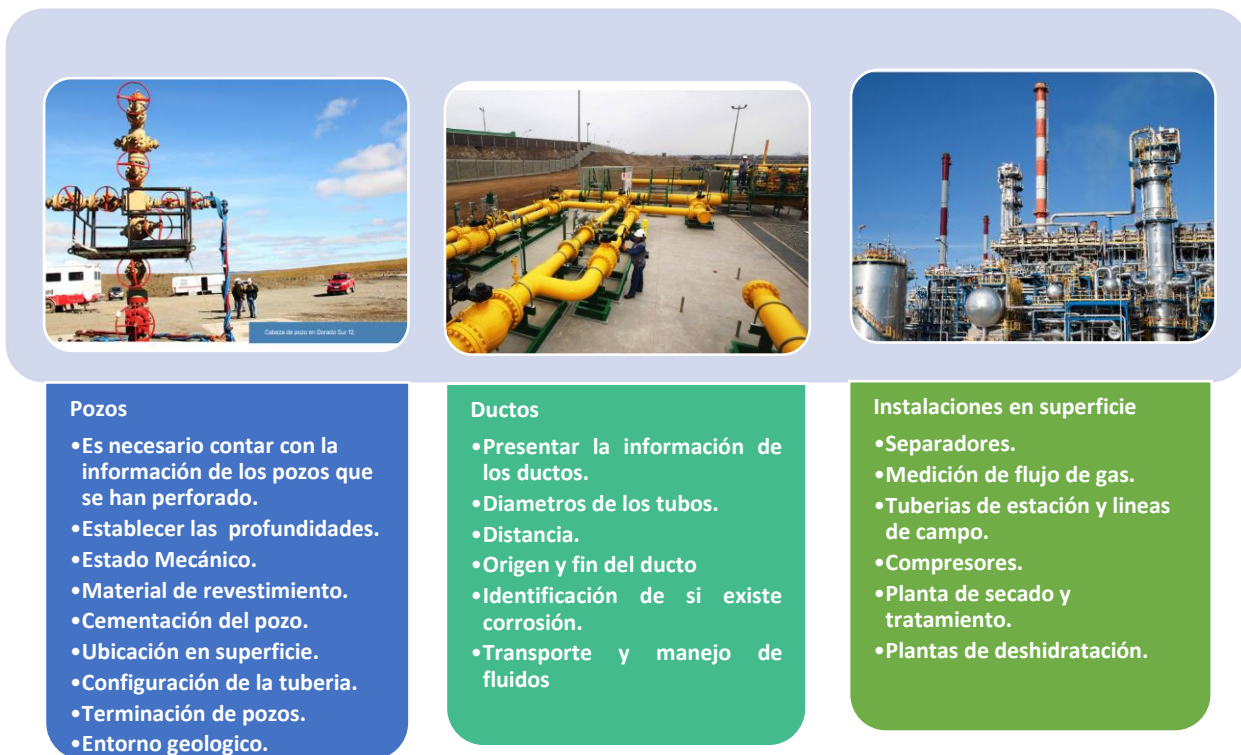
Figura 74. Infraestructura principal para el almacenamiento.
