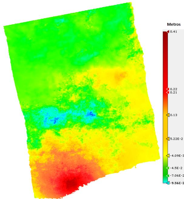
**Figura 5.6:** Mapa de desplazamientos sobre la superficie donde se observa la deformación a causa del sismo del 23 de junio del 2020 al centro de la imagen en color azul corresponde a los distintos cuerpos de agua de la zona. Los desplazamientos han sido calculados con los valores de la fase desvuelta en radianes y fueron transformados a metros.
