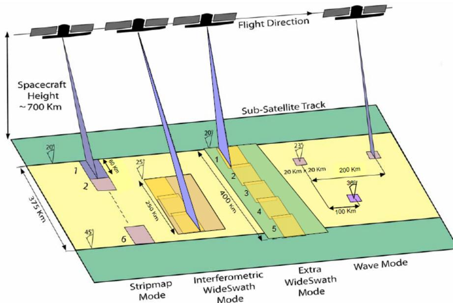
**Figura 3.2:** Modos de adquisición Sentinel 1 Fuente: (ESA, 2023).
