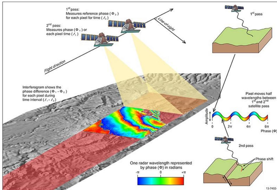
**Figura 2.6:** Región de la formación de un interferograma mediante la adquisición de dos imágenes SAR de la misma región en momentos diferentes. Si la superficie se mueve entre las dos adquisiciones, se registra un cambio de fase. Un interferograma mapea este cambio de fase espacialmente. Consultada de: Geoscience Australia.
