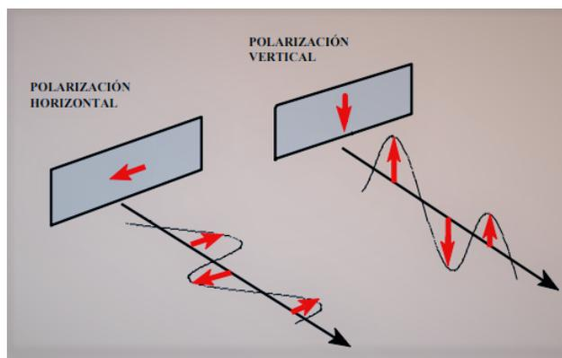
**Figura 2.5:** Esquema de polarizaciones vertical y horizontal.
