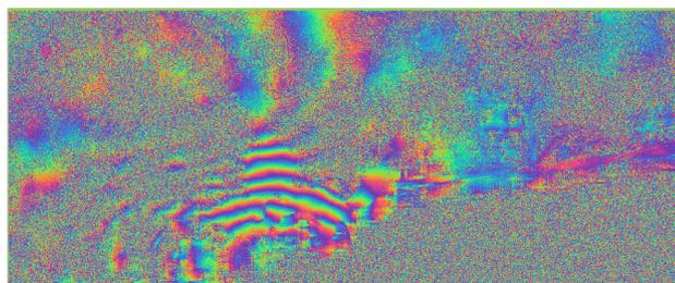
**Figura 5.12:** La imagen muestra la diferencia de fase entre las imágenes utilizadas después del filtrado y multilooking. Se observa que son más visibles las franjas interferométricas, así como zonas con alta decorrelación por el cambio de geometría en el periodo estudiado
