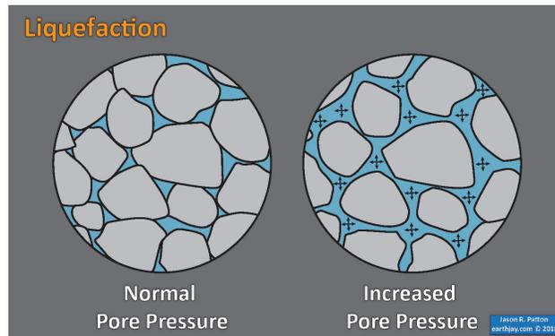
**Figura 1.6:** Proceso de licuefacción: (Patton, 2018).
