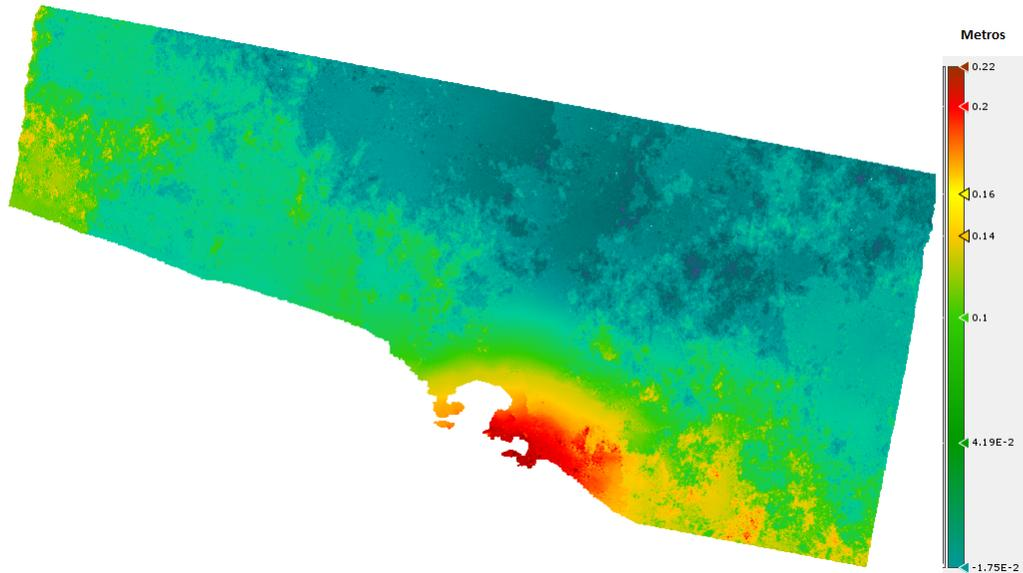
**Figura 5.15:** Mapa de desplazamientos sobre la superficie donde se observa la deformación a causa del sismo del 7 de septiembre del 2021 al sur oriente de la imagen. Los desplazamientos han sido calculados con los valores de la fase desmenuada en radianes y fueron transformados a metros.
