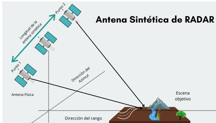
**Figura 2.3:** Esquema de una antena sintética de Radar.
