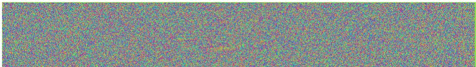
**Figura 5.10:** Interferograma en crudo. El interferograma se obtiene del cálculo del complejo conjugado de la primera imagen (maestra) por la segunda (esclava) obteniendo la diferencia de fase. Se puede observar la presencia del ruido denominado *Speckle* que no puede ser eliminado totalmente, pero mediante la utilización de filtros puede ser reducido.
