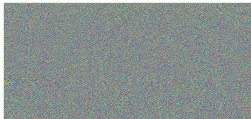
**Figura 5.1:** Interferograma en bruto. Se puede observar la presencia del ruido denominado Speckle que no puede ser eliminado totalmente, pero mediante la utilización de filtros puede ser reducido.
