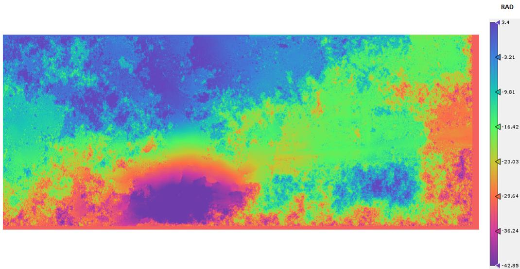
**Figura 5.13:** En la imagen se observa la fase desenvuelta a través de la utilización del software SNAPHU. Los valores de deformación están en radianes.
