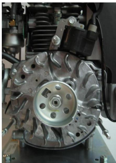
Figura 4.2 Sistema transistorizado (Motor Honda 50 cc).
