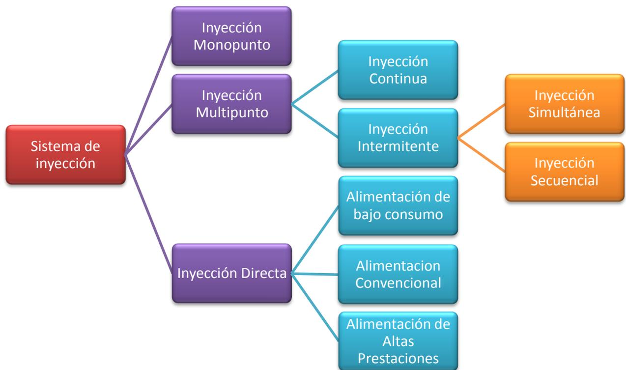
Figura 3.8 Principales tipos de inyección
