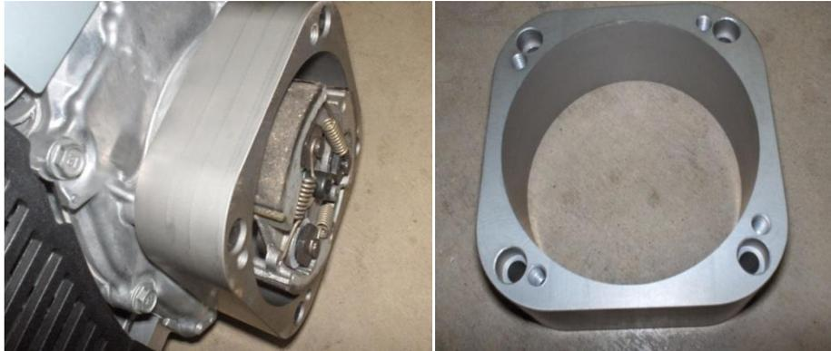
Figura 4.10 Adaptador para el sistema de tracción
