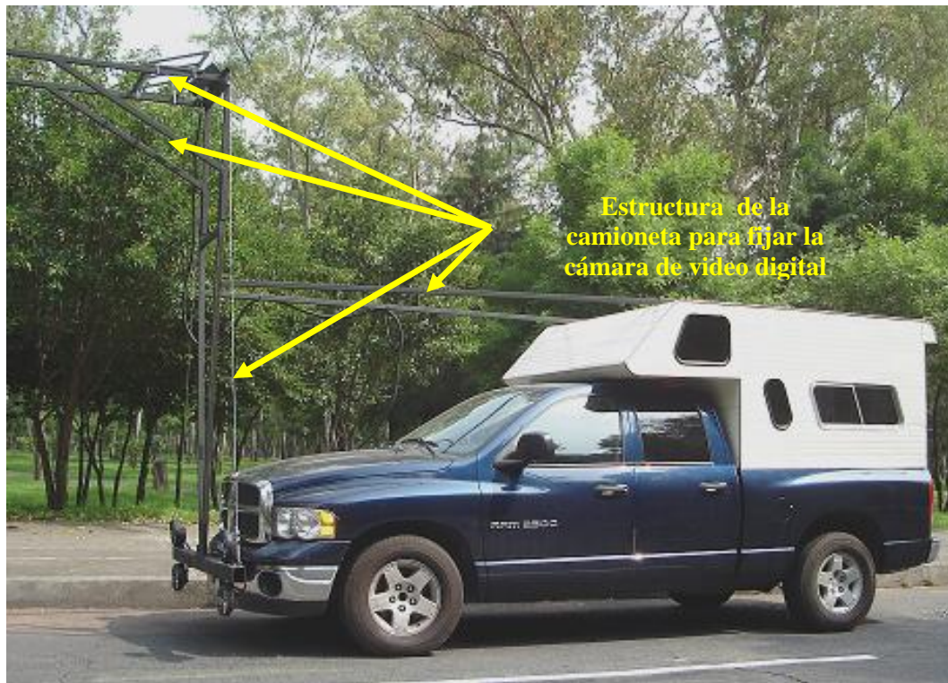
Figura 2.45 Camioneta equipada con una estructura metálica donde se monta la cámara
