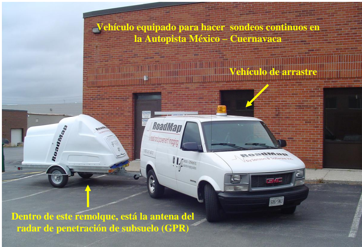
Figura 2.1 Vehículo de arrastre y remolque con el radar de penetración de subsuelo
