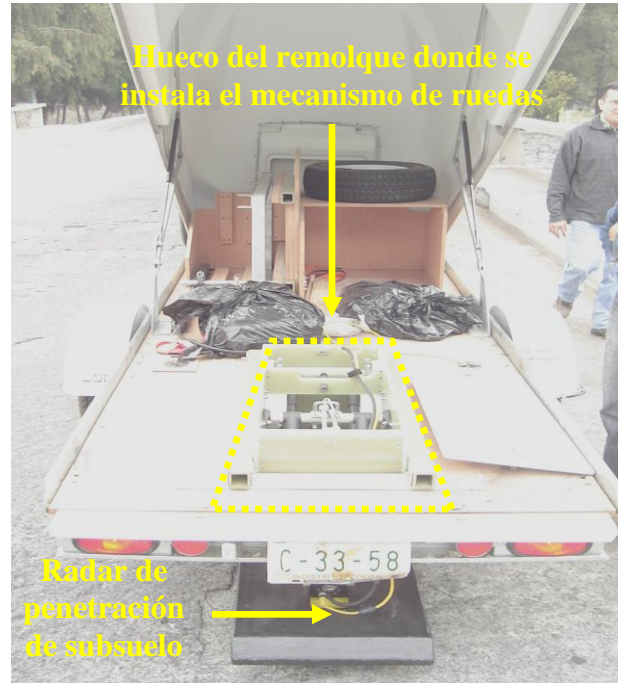
Figura 2.6 Radar de penetración de subsuelo (GPR) armado al 100% para el estudio
