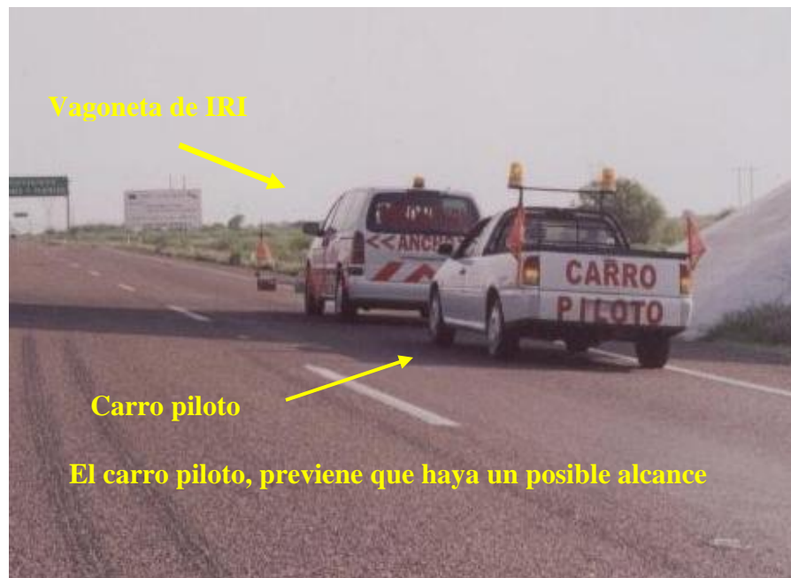
Figura 2.37 Vagoneta del IRI y su carro piloto en la obtención de datos
