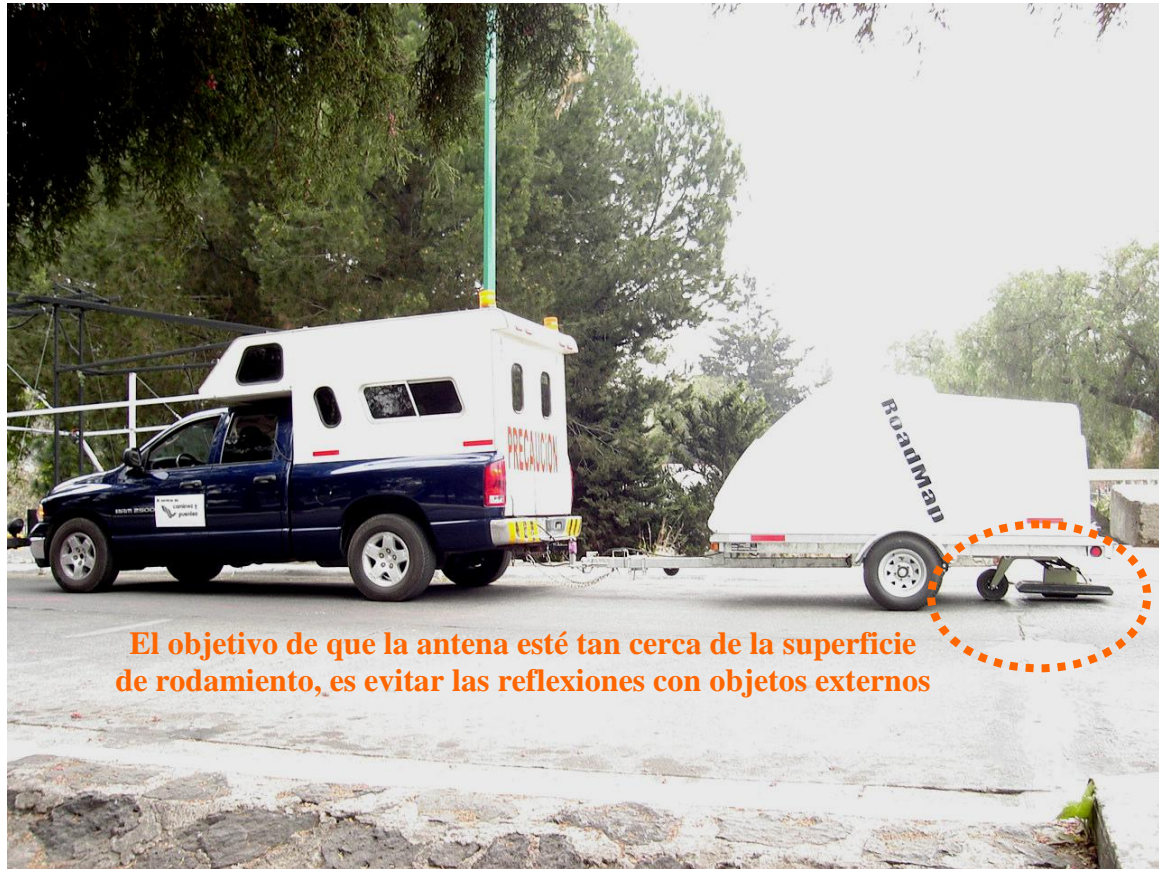
Figura 2.4. La antena bipolar se encuentra a 1 cm de la superficie de rodamiento
