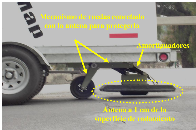
Figura 2.7 Equipo de GPR (mecanismo de ruedas y antena) en operación
