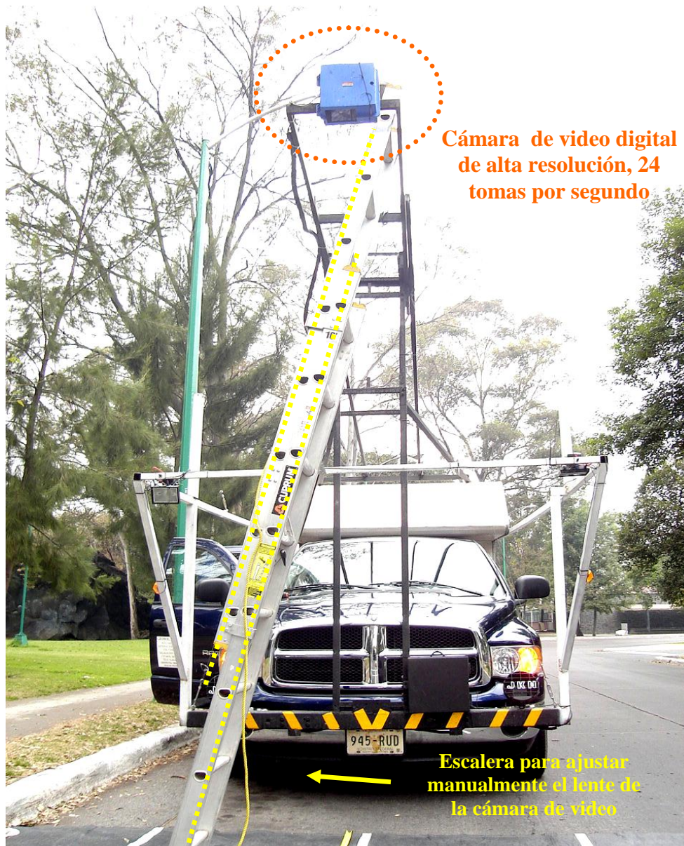
Figura 2.43 Vehículo equipado para el levantamiento de deterioros con video digital
