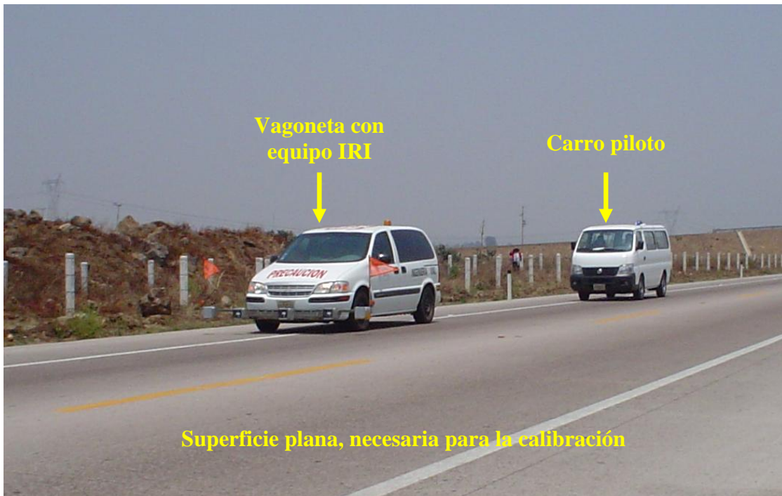
Figura 2.30 Tramo carretero plano para la calibración del instrumento de medición
