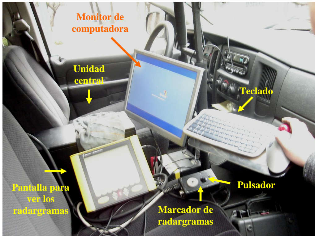
Figura 2.2 Interior del vehículo de arrastre y parte del equipo de GPR
