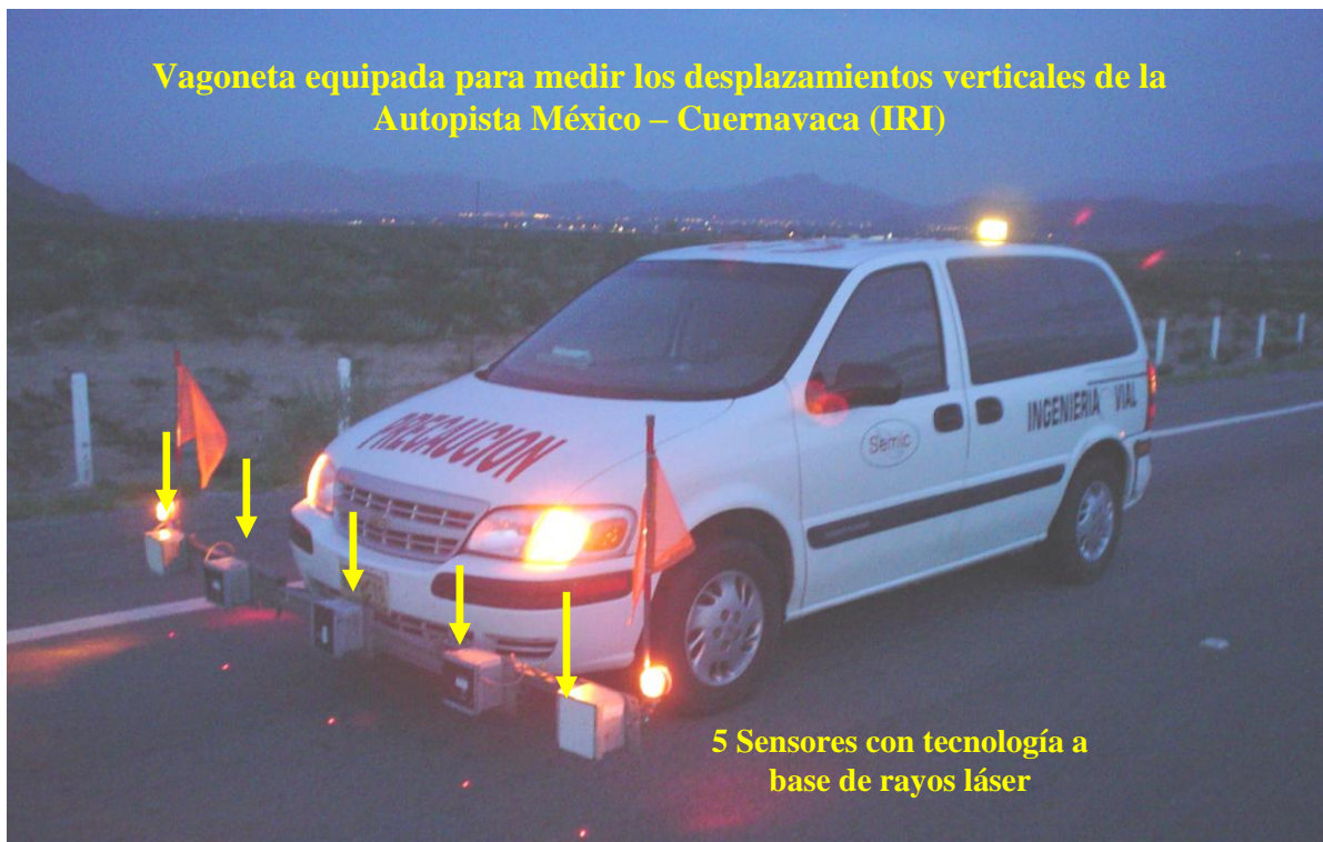
Figura 2.26 Vagoneta equipada para medir el IRI y la profundidad de roderas
