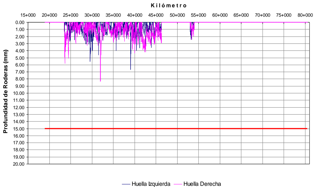
Figura 4.22 Gráfica de la profundidad de roderas para el sentido 1, carril 3 (S1C3)
