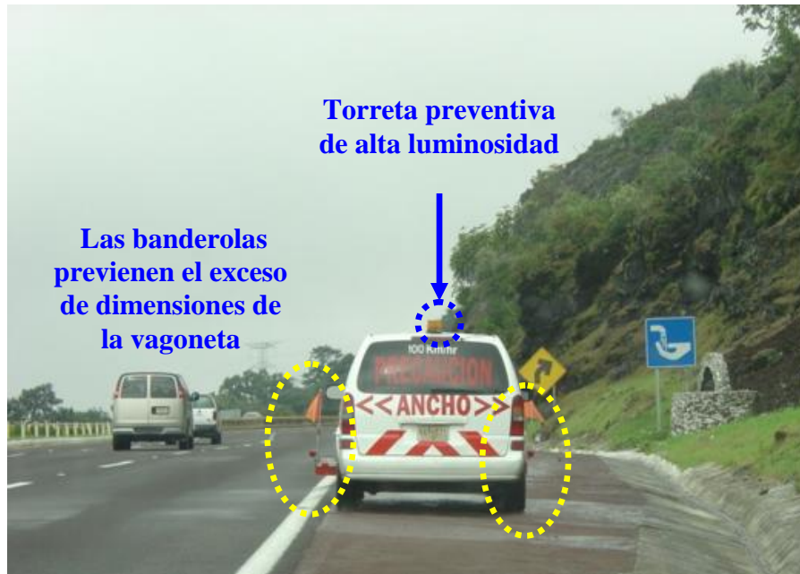
Figura 2.36 Señalamiento preventivo de la vagoneta IRI en operación
