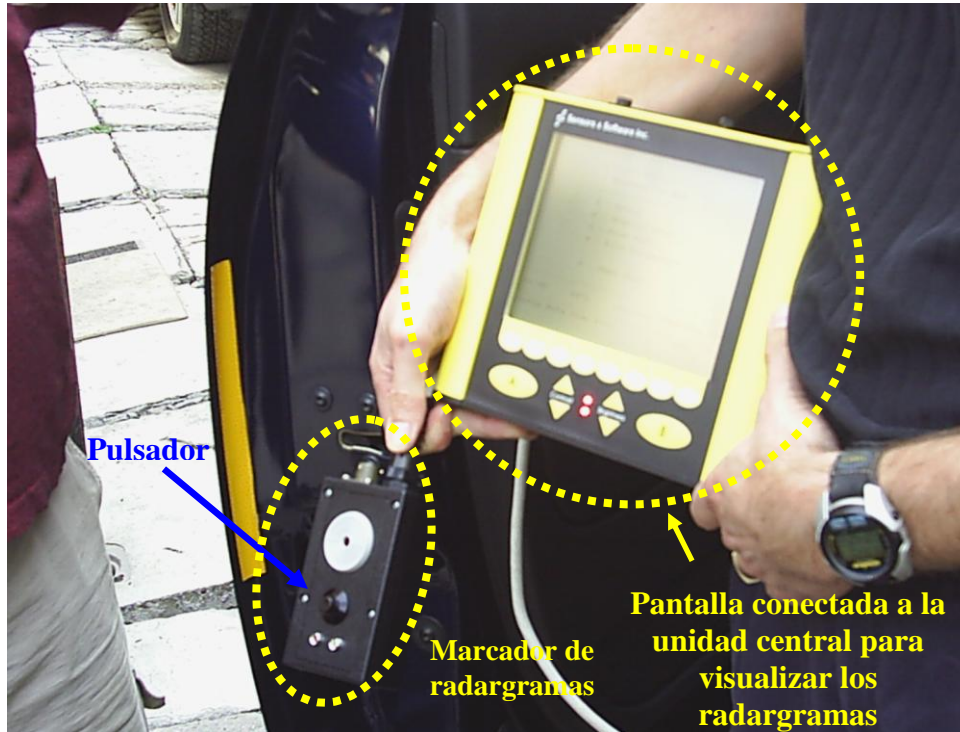
Figura 2.8 Equipo de visualización y marcación del GPR
