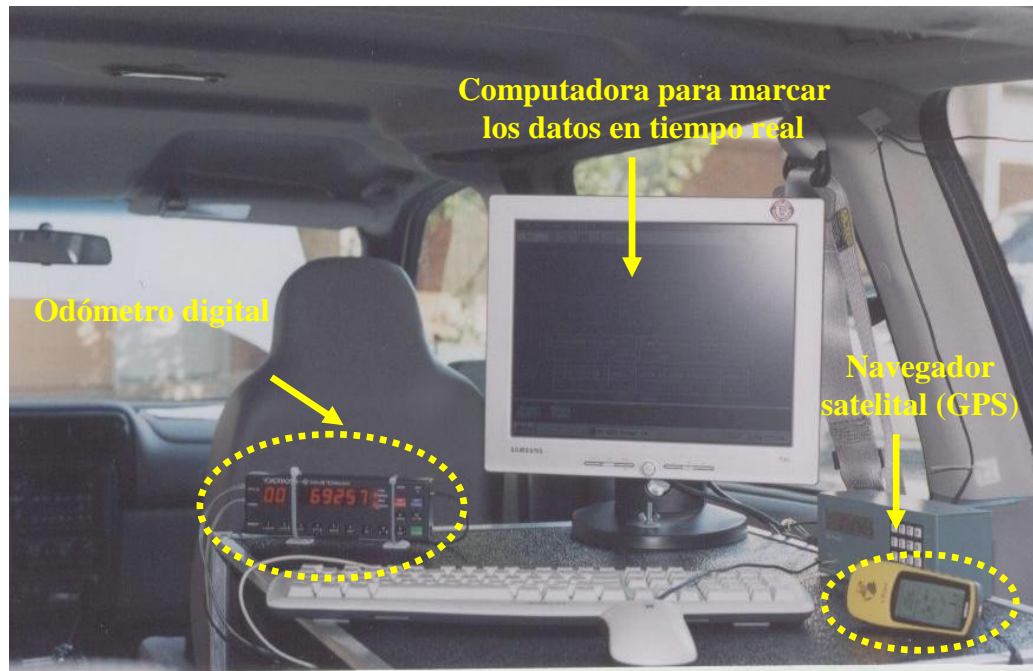
Figura 2.28 Interior de la vagoneta con el equipo IRI
