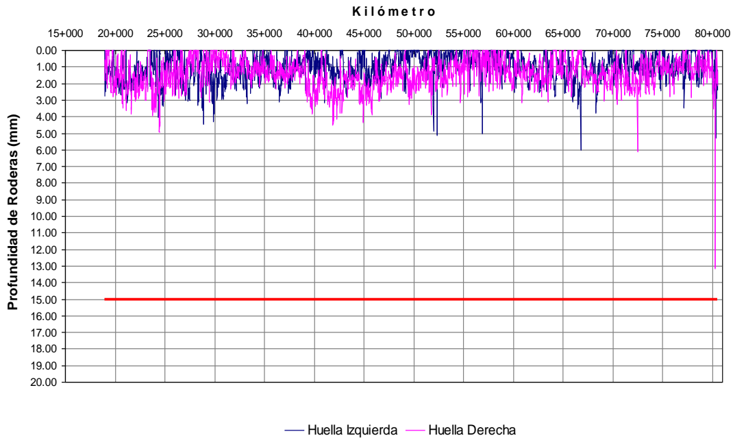
Figura 4.21 Gráfica de la profundidad de roderas para el sentido 1, carril 2 (S1C2)
