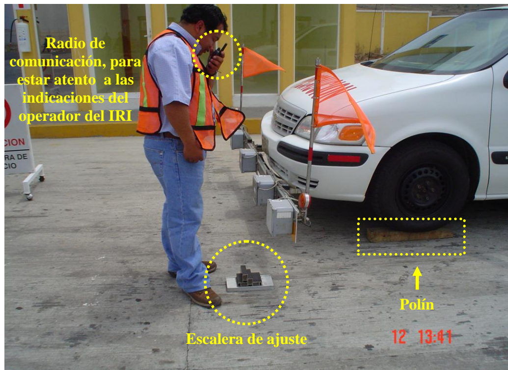
Figura 2.31 Calibración de los rayos láser con la pequeña escalera de aluminio
