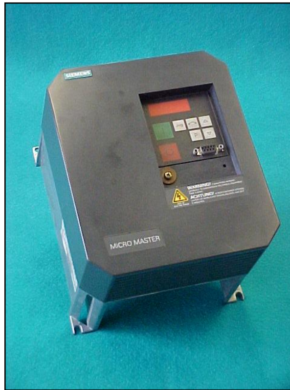
Figura 3.51. Inversor para el control del motor.
