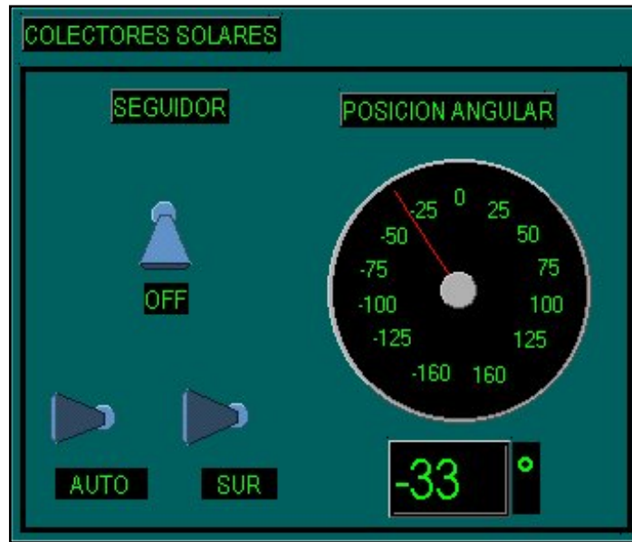
Figura 6.14. Panel de control de colectores.
