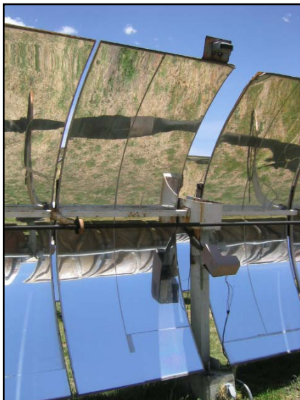
Figura 4.26. Colocación de sensores de intensidad luminosa.
