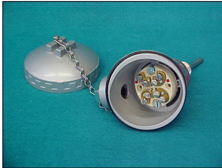
Figura 3.36. Interior de la cabeza del sensor.
