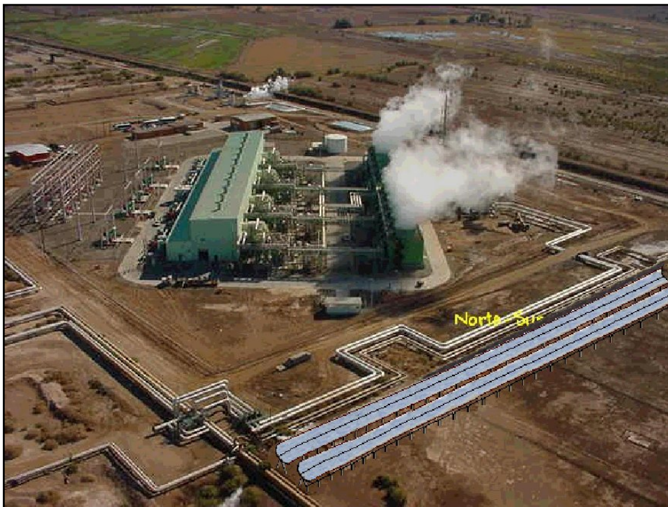
Figura 5.18. Sistema híbrido geotérmico-solar.
