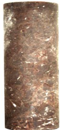
Los resultados de laboratorio demostraron que el material posee alta resistencia y baja deformabilidad. El valor de densidad húmeda promedio fue de 24.09 (kN/m<sup>3</sup>).
