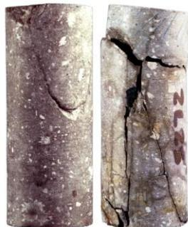
Figura 2.21. Probeta plastificada, en este tipo de rotura el material ha sido sometido a un esfuerzo de confinamiento mayor del que se tenía previsto y el esfuerzo desviador plastifico el material.
