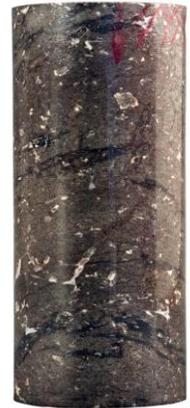
De los resultados de laboratorio se deduce que es una muestra de resistencia alta y baja deformabilidad. El valor de densidad húmeda promedio fue de 24.71 (kN/m3).
