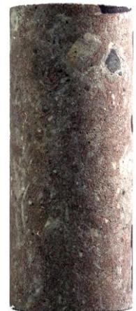
un grupo de menor resistencia y un grupo de mayor resistencia. La densidad húmeda promedio resultó de 23.14 (kN/m<sup>3</sup>) en el caso de las probetas de resistencia mayor y de 22.95 en el caso de las probetas de resistencia menor.
