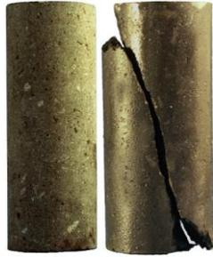
Figura 2.19. Tipo de rotura Mohr-Coulomb por la matriz en el estado Elástico-lineal.
