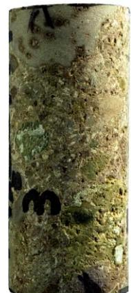
De acuerdo con los ensayos y el criterio de la ISRM (1978) se le clasifica como una roca débil, o de baja resistencia y de deformabilidad
