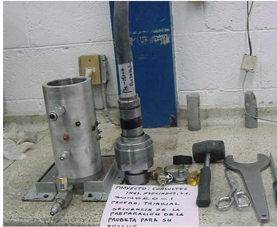
Figura 2.15. Equipo y material para la prueba de compresión triaxial
