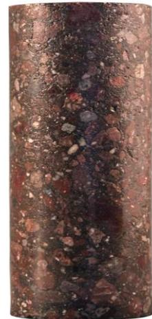
Según el criterio del ISRM (1978) se le clasifica a la muestra como de resistencia media. El valor de densidad húmeda promedio fue de 24.09 (kN/m<sup>3</sup>).
