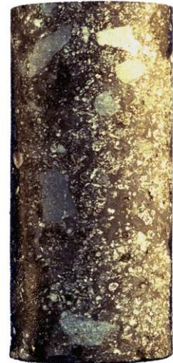
A partir de los ensayos se deduce que es una roca de muy alta resistencia y dureza. Tiene muy baja deformabilidad. Su densidad húmeda promedio resultó de 25.19 (kN/m3).
