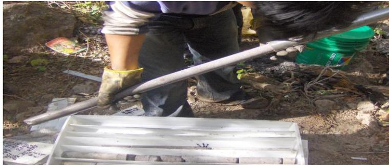
Figura 1.8 Extracción de la muestra del portatestigo para ser colocada en la caja para la protección y su posterior traslado.
