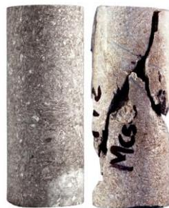
Figura 2.18. Tipo de rotura cuasifrágil en lascas verticales, en donde el esfuerzo de confinamiento fue nulo.
