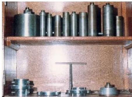
Figura 2.2 distintos diámetros de broca para la extracción de los núcleos
