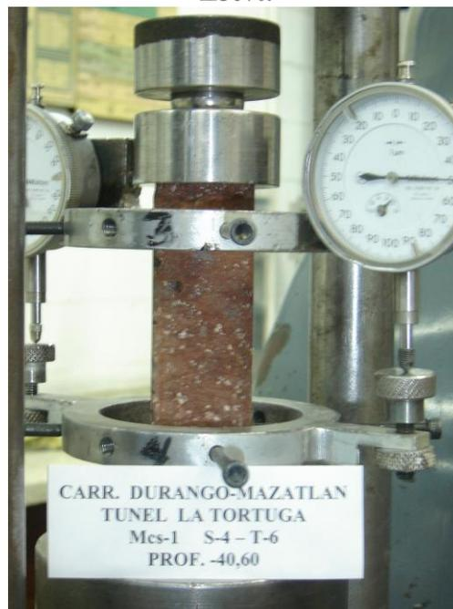
Figura 2.12. Probeta montada con el equipo de laboratorio.
