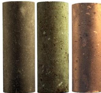
Figura 2.6 juego de probetas para el ensaye triaxial
