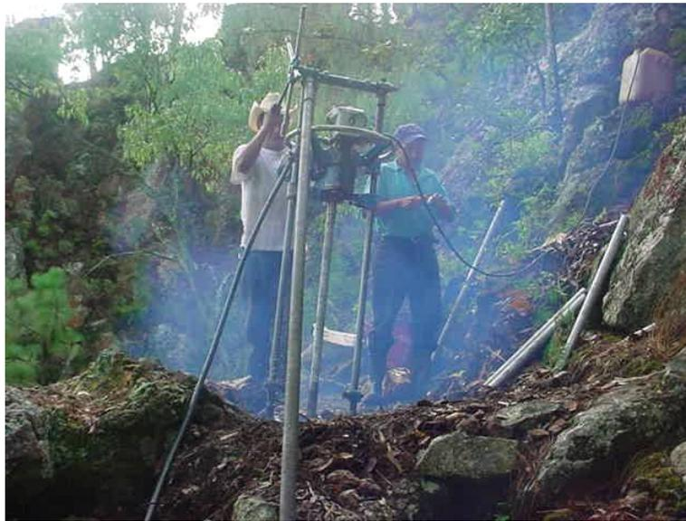
Figura 1.6. Operación de una sonda Winkie.
