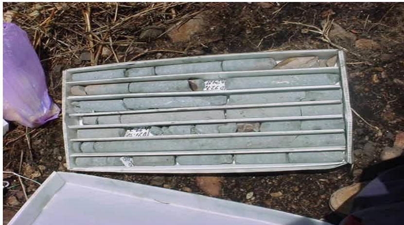
Figura 1.9 Caja de sondeo con sus respectivos tramos perforados.
