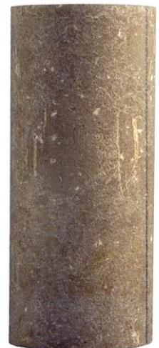
de 25.30 (kN/m<sup>3</sup>) en el caso de las probetas de resistencia mayor y de 24.42 (kN/m<sup>3</sup>) en el caso de las probetas de resistencia menor.
