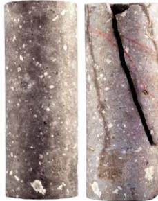
Figura 2.20. Tipo de rotura Mohr-Coulomb en el estado plástico. Este tipo de rotura también pudo haber sido condicionado por los clastos de la probeta y alguna recristalización de los minerales de la roca.
