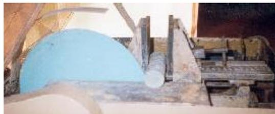
Figura 2.3 corte del núcleo de roca.
