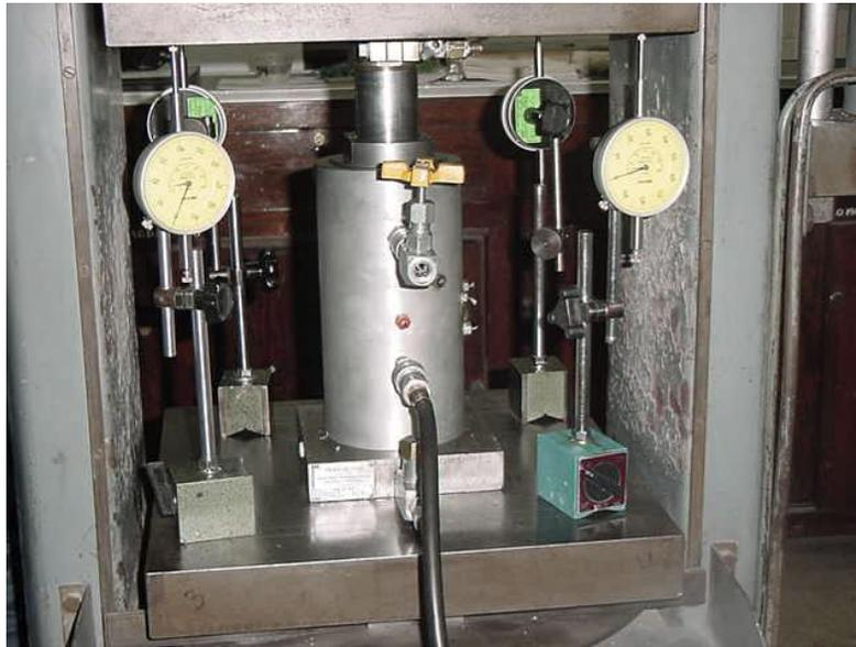
Figura 2.16. Cámara triaxial montada en la prensa de carga junto con indicadores de carátula
