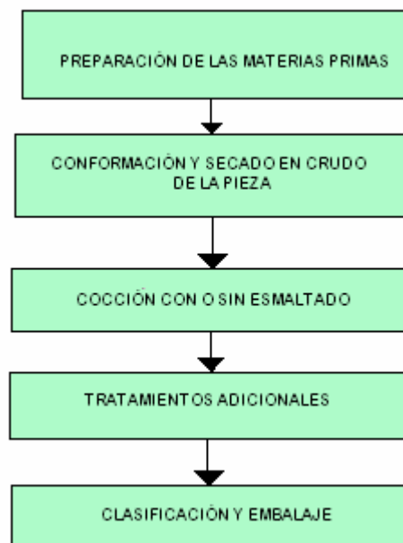
Figura IV.2. Proceso de producción 12
