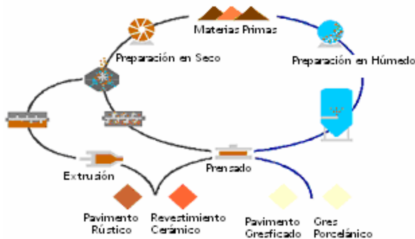
Figura IV.3. Fabricación de Baldosas Cerámicas 12
