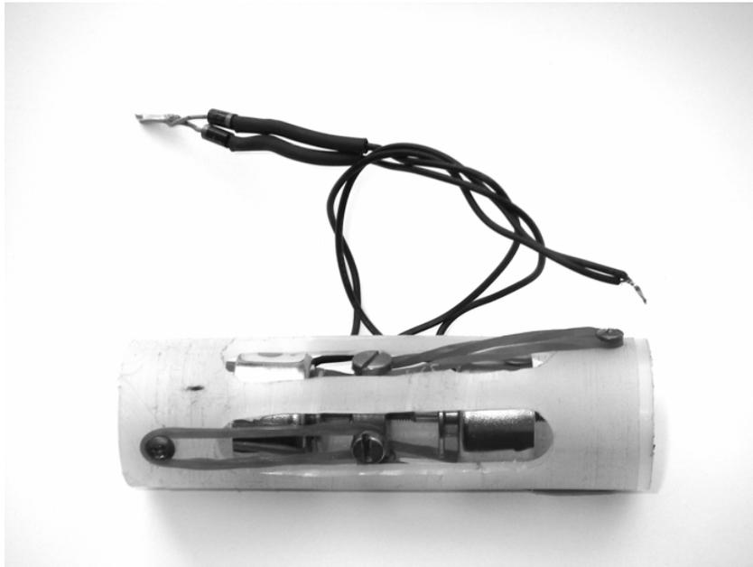
Figura 8.4.1 Prototipo del vibrador con solenoides
