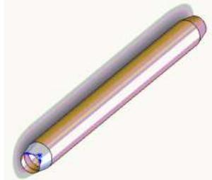
El **elemento terminal** (5) se diseñó en aluminio, este elemento es la base donde más tarde podremos colocar algún aditamento necesario para realizar tareas específicas.
