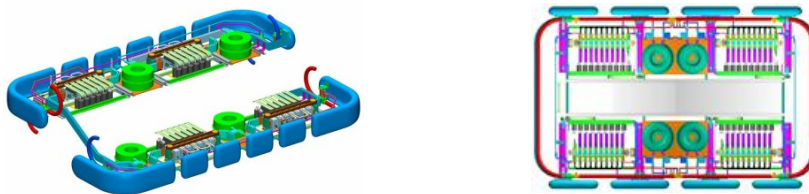
Fig. 1.6 dibujo de una válvula con cuatro conexiones en serie de módulos de tiristor y reactancia
