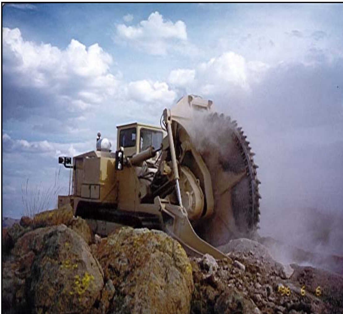
FOTOGRAFÍA V.34 “ZANJADORA DE DISCO MODELO 1100”
