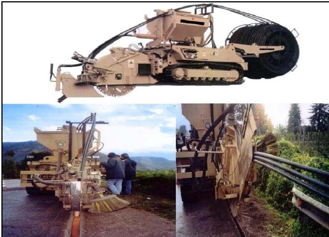
FOTOGRAFÍA V.39 “ZANJADORA URBANA (CITY TRENCHER)”
