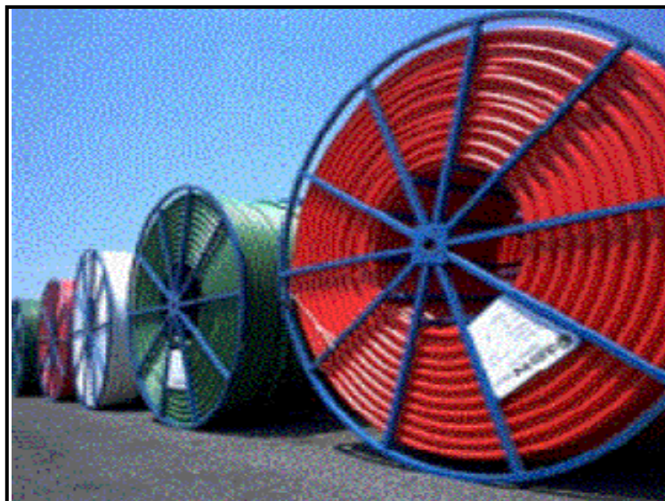
FOTOGRAFÍA V.3 “CARRETE PARA EMBALAJE DE TUBOS HDPE”
