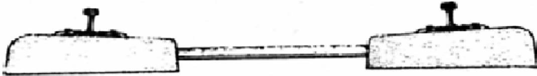
El acero de refuerzo pesaba 6.4kg. en los 2 blocks que se debían separar mediante la barra de hierro estructural (ángulo) de 2m. de longitud y un peso de 9kg. para tráfico liviano y en regiones de baja oxidación. Para tráfico pesado, la barra de unión llegaba a pesar 15kg. y para prevenir la oxidación, se le aplicaba pintura ahulada.
