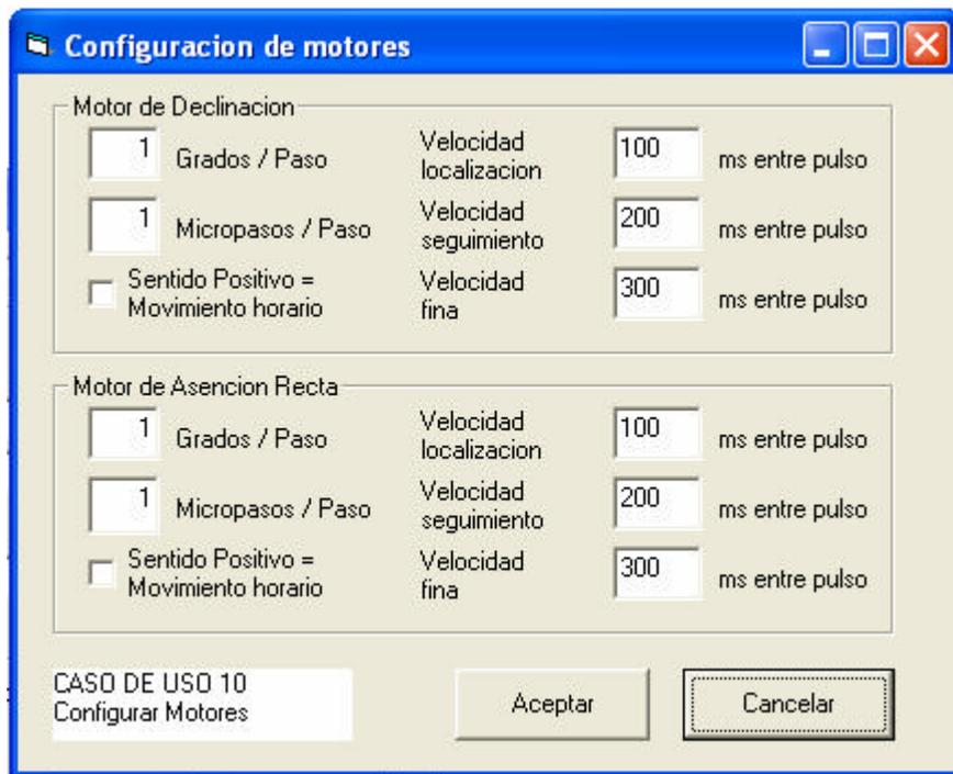
Pantalla de configuración de motores
