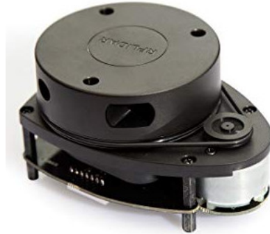
Figura 3.6: Telémetro láser de escaneo RPLIDAR A1 M8.
