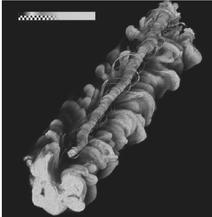
1.4.9 Isosuperficie que muestra el movimiento del combustible en un jet
