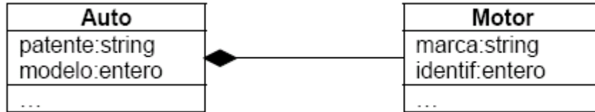
Figura 2.3.9 Agregaciones entre clases
