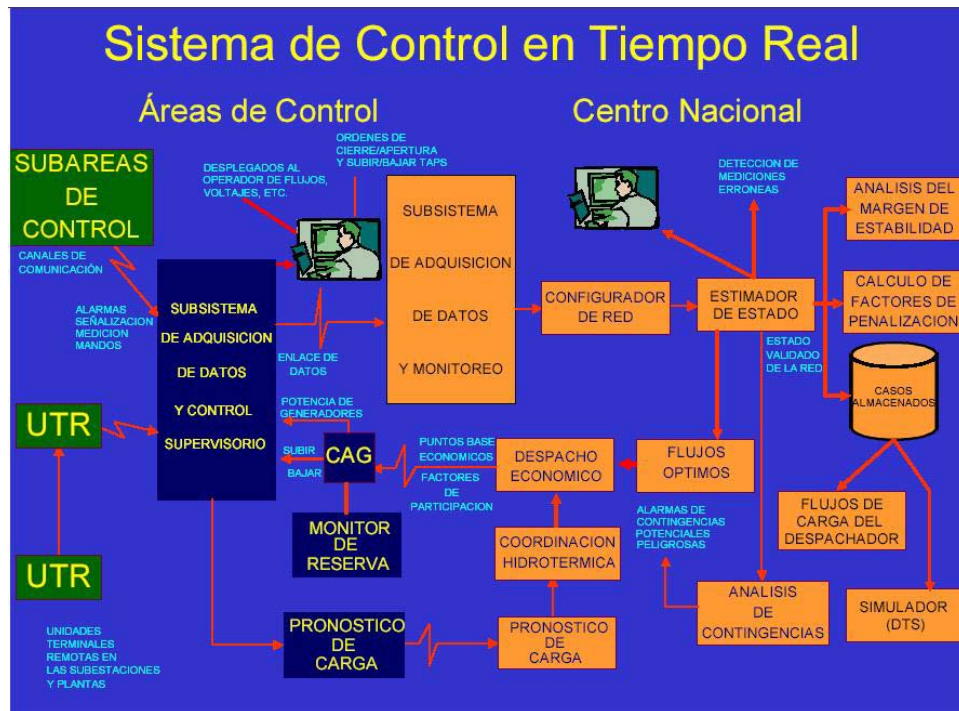
Figura 4.2.- Sistema de Control En Tiempo Real.
