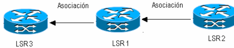
Figura 5.3.1.4.1. La Arquitectura MPLS permite a un LSR distribuir una etiqueta a otro LSR que no lo requiera explícitamente
