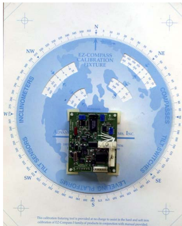
Figura 2.11 Diagrama de calibración contra anomalías, de la brújula electrónica.
