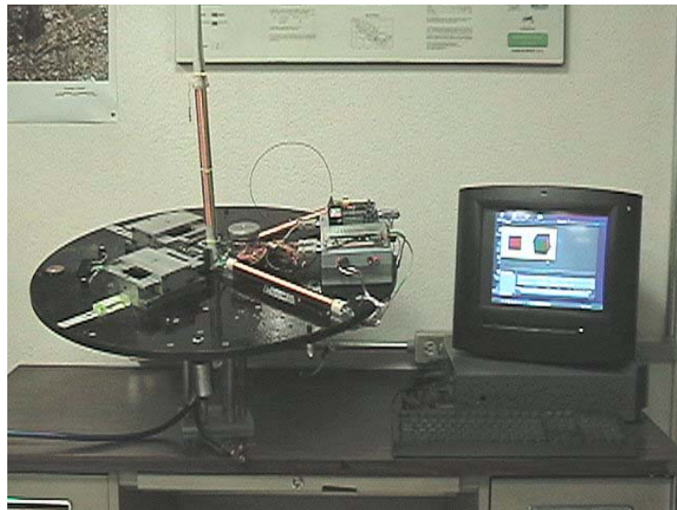
Figura 6.2. Arreglo experimental donde se muestra la pantalla sobre la que se grafican los datos de orientación, capturados de manera remota por el sistema de monitoreo.
