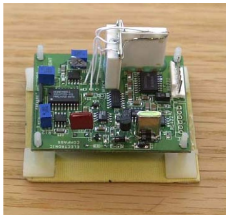
Figura 1.8. Brújula electrónica dotada con dos inclinómetros.
