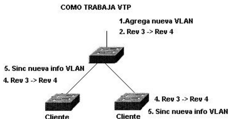
Figura 4.18 Forma de operar de un VTP
