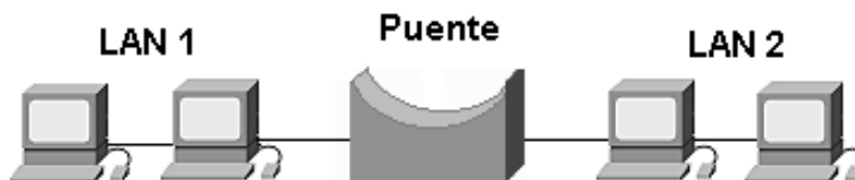
Figura 2.13 Unión de dos redes mediante un puente
