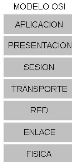
Figura 1.11 Capas del modelo OSI
