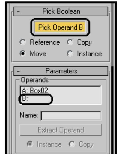
Realizaremos cuatro operaciones booleanas, donde el operando A es el tablero (Box02), y el operando B son las cajas secundarias que servirán para hacer los huecos al tablero (Box03, Box04, Box05, Box06).
