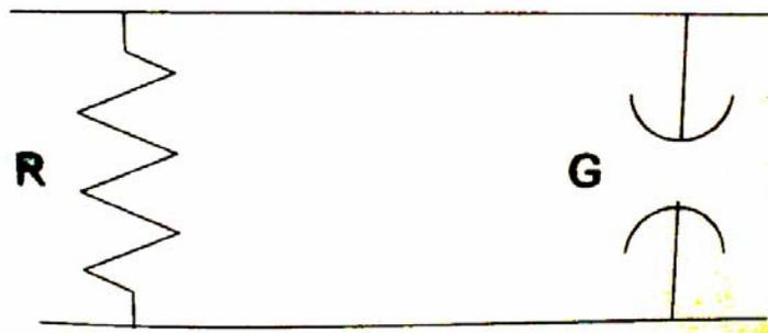
Figura 3.4. Diagrama típico de una falla
