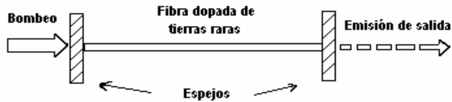
Figura 1.7. Diagrama de una fibra láser
