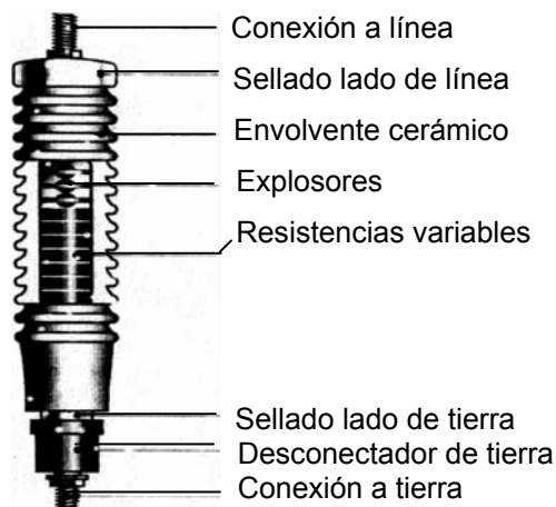
FIGURA 3.32 COMPONENTES DE UN APARTARRAYOS DE CARBURO DE SILICIO
