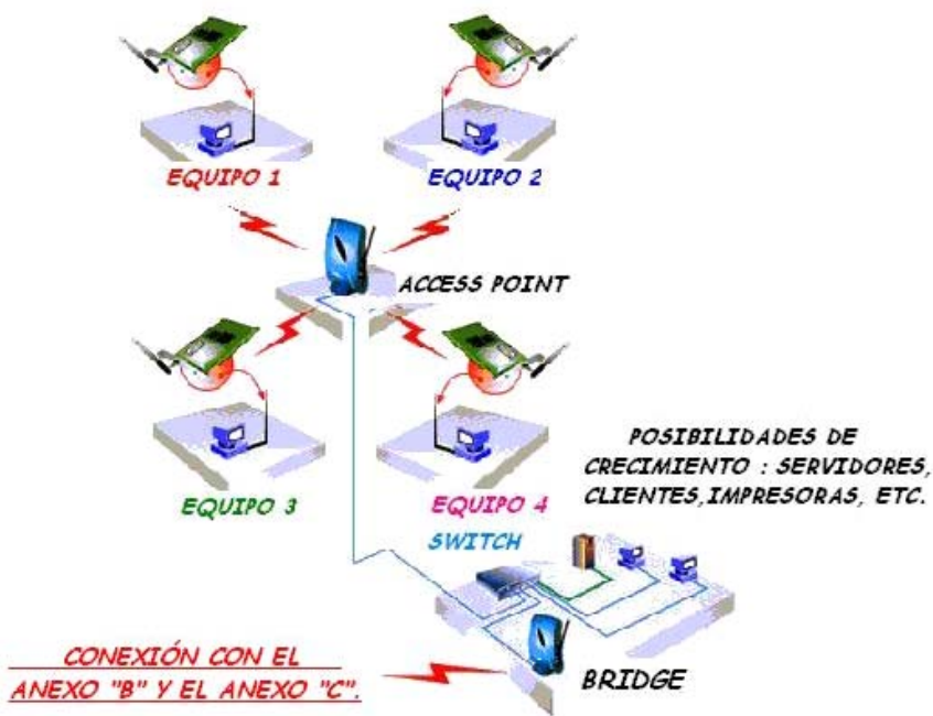
Figura 2.10. Conexiones de la Central "A"
