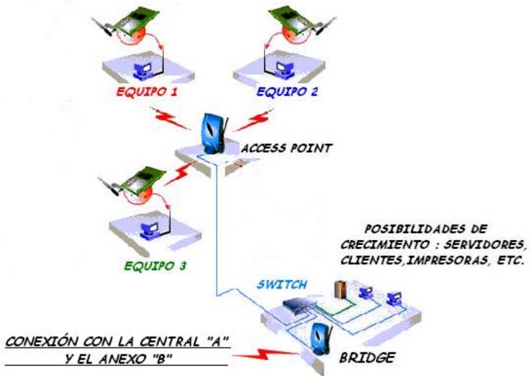
Figura 2.12. Conexiones del Anexo "C"
