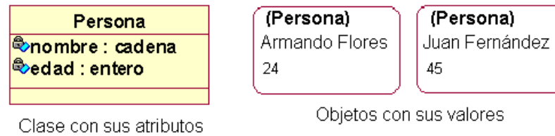
Figura 2.2. Notación OMT para los atributos de una clase y de un objeto
