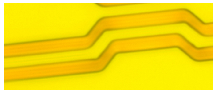
Figura 5.3 Ejemplo de un buen revelado en una estructura de prueba tras encontrar los parámetros correctos.
