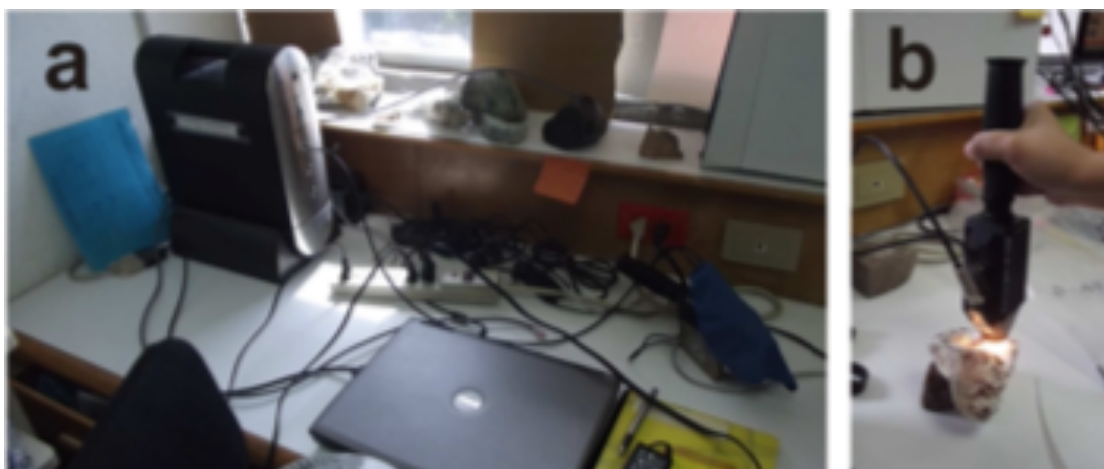
Figura 3.1. a) Espectrómetro portátil LabSpec Pro (Analytical Spectant Devices, Inc). b) irradiador de muestra.
