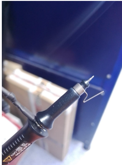
Figura 13.4: Punta del osciloscopio indicada para medir las salidas y entradas del comparador LT1719.
