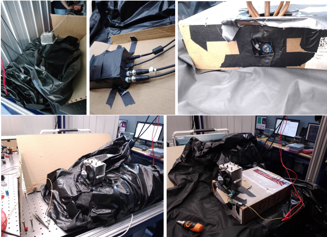
Figura 17.8: Sistema SPAD aislado de la luz ambiental.
