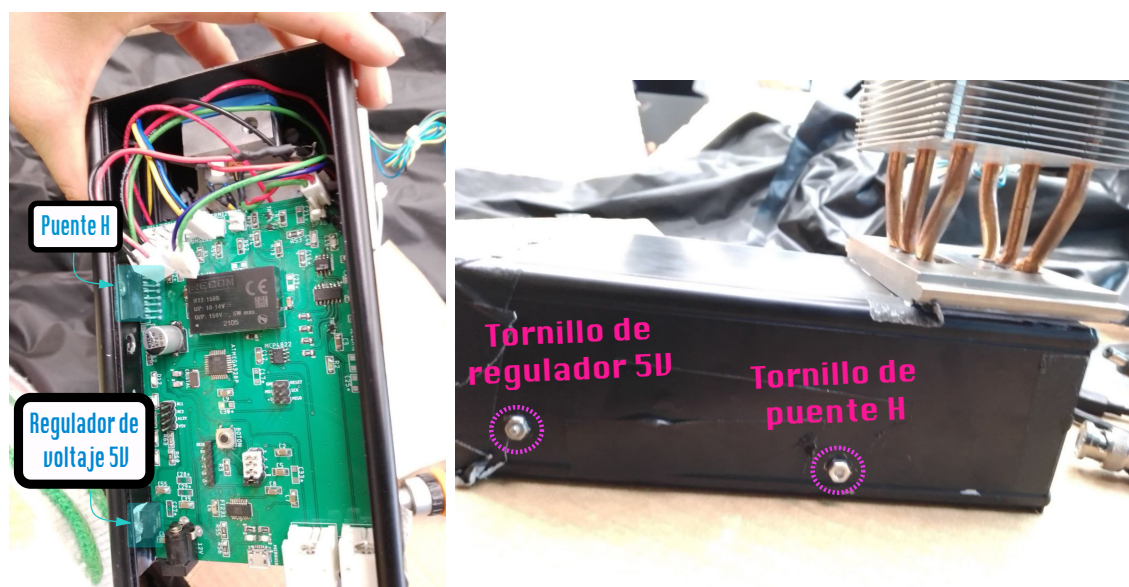
Figura 14.9: Puente H y regulador de voltaje de 5V atornillados para disipar el calor que generan.
