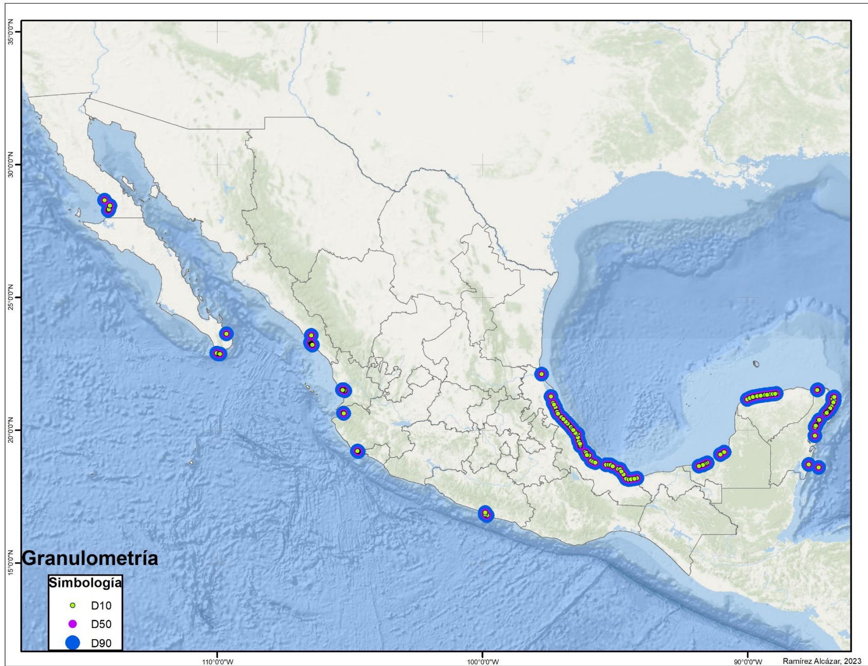
Figura 3.1. 9. Mapa de la distribución de los diámetros característicos de la BD del GICP obtenidos a través del CAMSIZER
