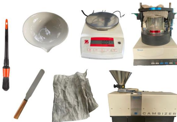
Figura 2.2.1. 2. Instrumentos utilizados para la obtención de la granulometría por CAMSIZER
