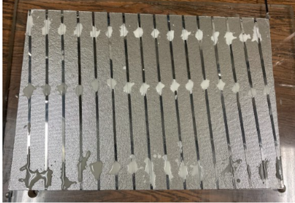
Figura 2.7: Fotografía de la cementación de la resistencia eléctrica.
