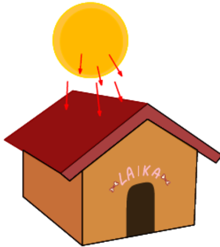
Figura 1.4: Ejemplo de transferencia de calor por radiación.
