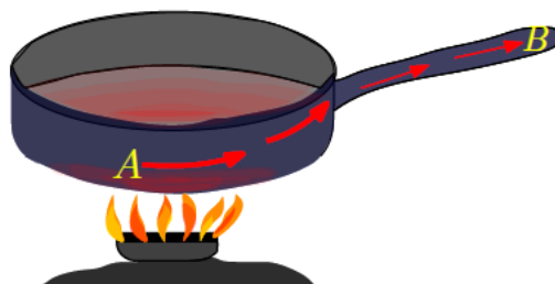
Figura 1.3: Ejemplo de transferencia de calor por conducción.
