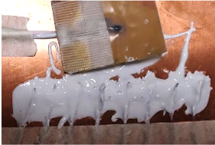
Figura C.2: Termopares y termistor sobre la placa de cobre cubiertos de pasta térmica.
