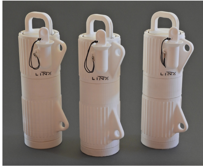
Figura 24: Fotografía con 3 recolectores ensamblados, pintados y finalizados. Se aprecia la cuerda negra que va de la taparroscas al contenedor externo para muestras de ADN, cuya función es evitar que se pierda o se caiga la taparroscas cuando esta se abre bajo el agua.
