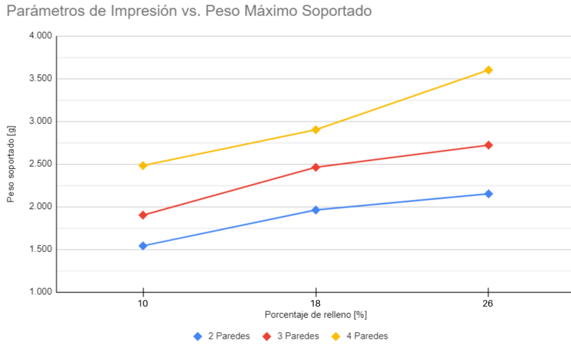
Figura 30: Gráfica que muestra los resultados del experimento al variar los parámetros de impresión de cada probeta. La línea azul representa las probetas con dos paredes, la roja con tres y la amarilla con 4. El eje de las abscisas muestra el porcentaje de relleno mientras que el eje de las ordenadas representa el peso máximo promedio soportado por las probetas antes de su ruptura.
