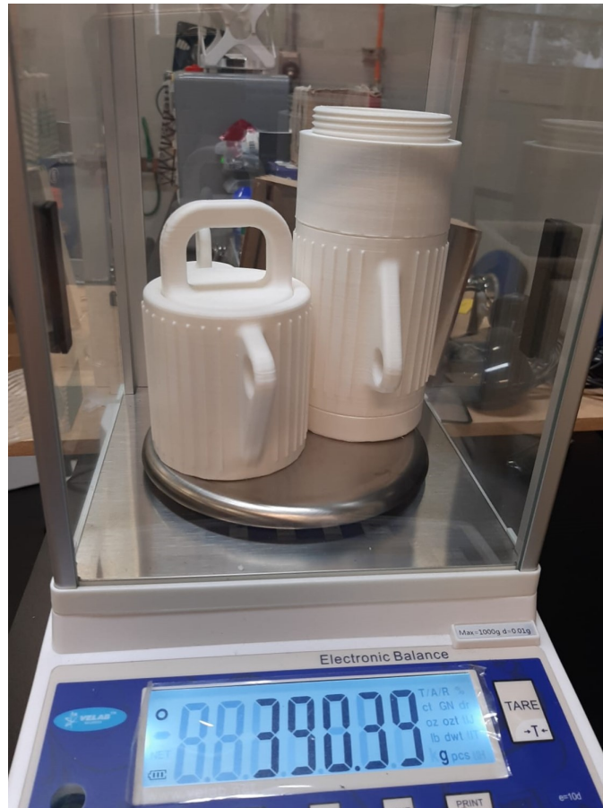
Figura 26: Peso total de un recolector individual con el plomo adentro. Se aprecia como el peso total corresponde con lo estipulado en los cálculos que se hicieron para determinar la cantidad de plomo y el estimado de masa del material en la tabla de cada componente.
