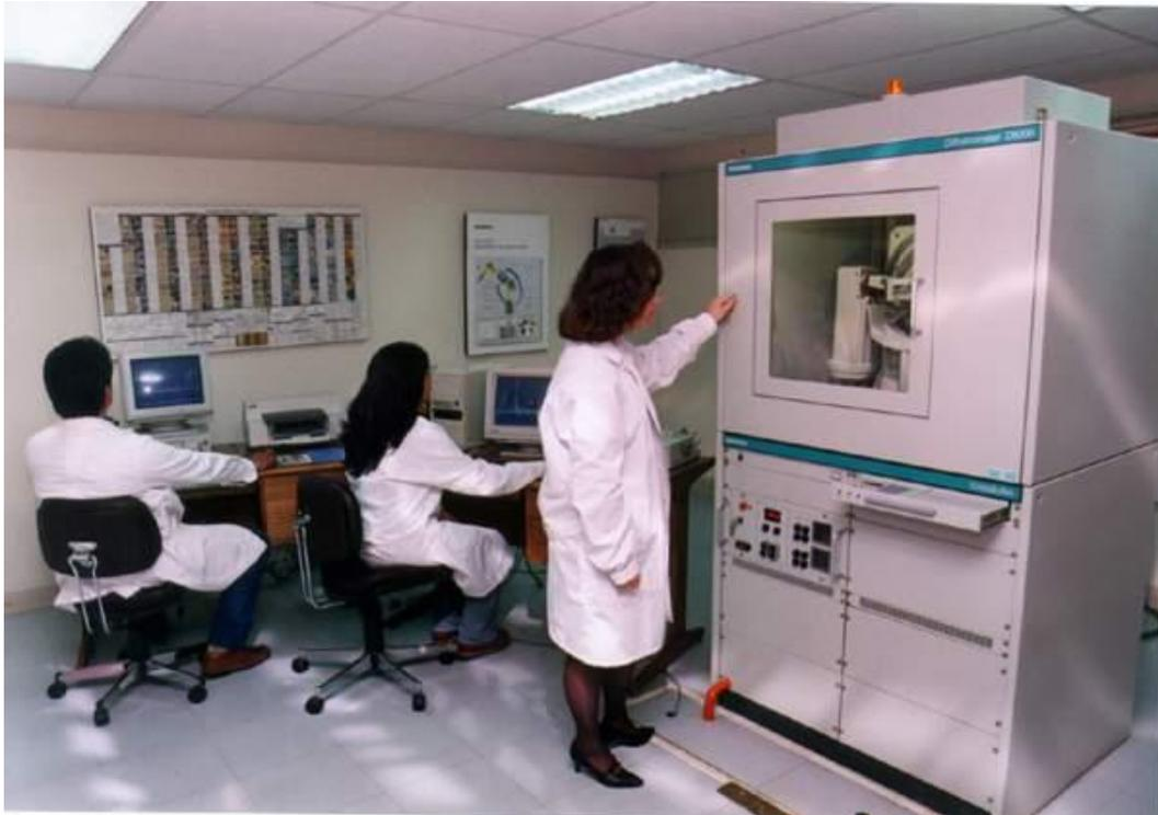
*Figura 1.5.5.1. Difractómetro Automático de Polvos Siemens modelo D5000, el cual se apoya en modernos programas computacionales de búsqueda e identificación de elementos y/o compuestos mediante la Base de Datos Internacional JCPDS (Joint Committee on Powder Diffraction Standards).*
