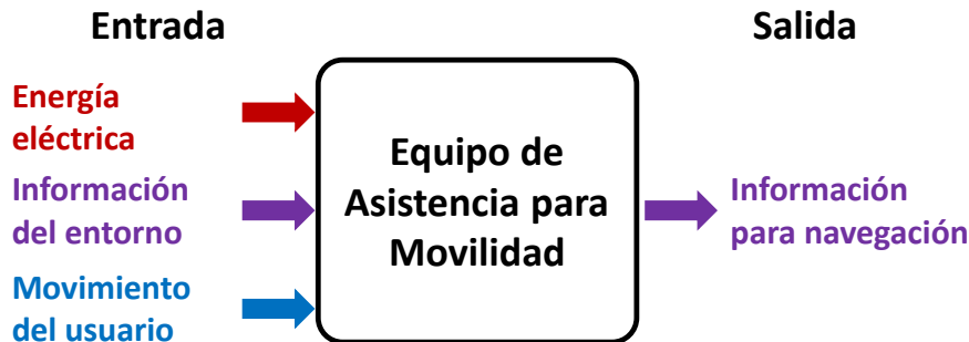
Figura 2.1: Representación de caja negra de un equipo de asistencia para movilidad para personas con debilidad visual.
