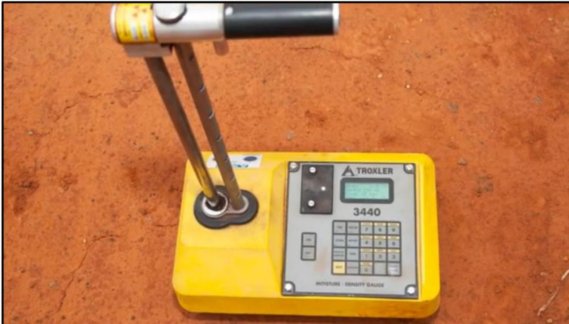
**Figura 10.** Medición de compactación y humedad con un Densímetro Nuclear
