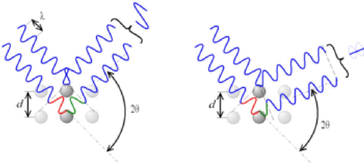
**Figura [3.2] Ángulo de desviación ( $2\theta$ ) que dará la interferencia constructiva (izquierda) y destructiva (derecha).**
