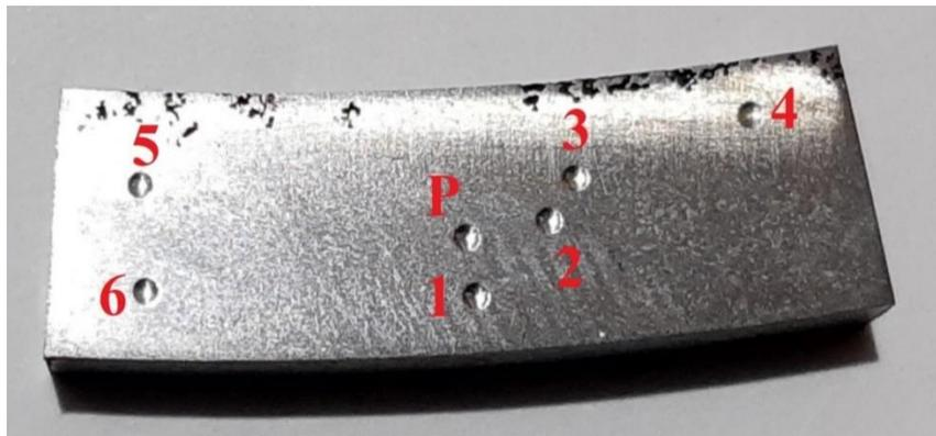
**Figura [5.9]. Huellas de los ensayos de dureza Brinell para la probeta de fundición nodular**
