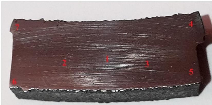
**Figura [5.12]. Zonas donde se realizó el ensayo Vickers en la fundición gris**
