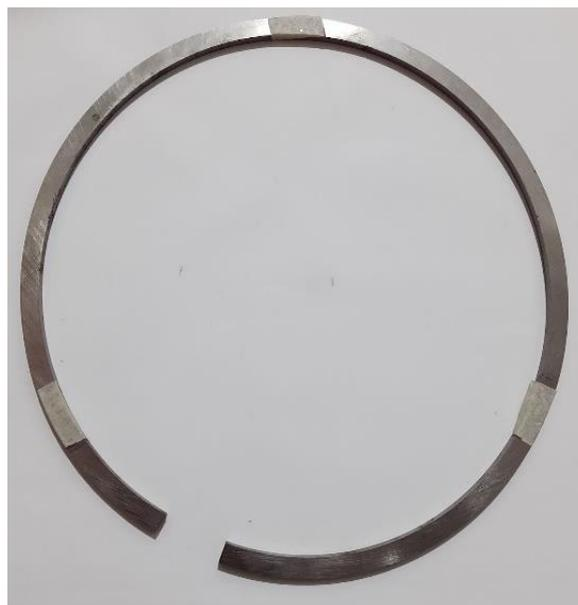
**Figura [4.6] Marcaje para el corte del anillo de fundición centrífuga horizontal a  $120^\circ$ .**
