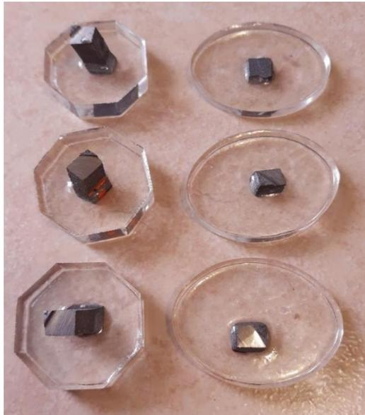
**Figura [4.16] Muestras montadas del anillo de arena. Estas mismas muestras se obtuvieron para el anillo de fundición centrífuga.**
