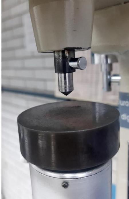
**Figura [5.3] Preparación del equipo Rockwell. Montaje de la base y el cono de diamante.**
