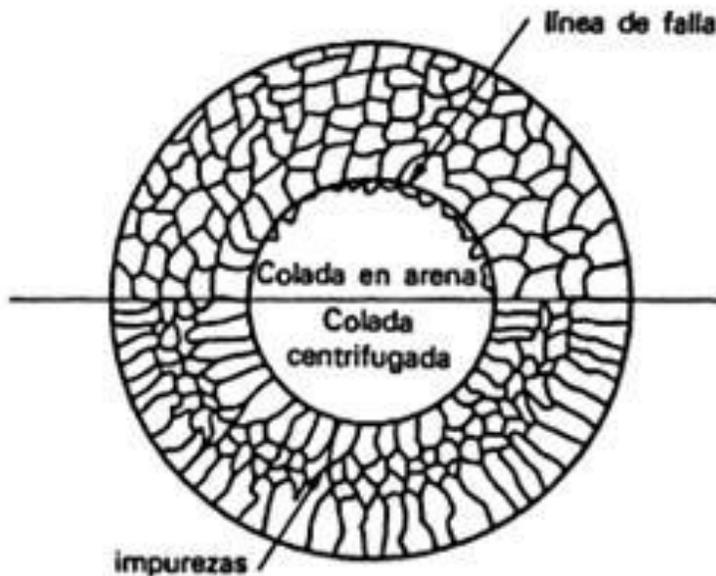
Figura [2.1] Comparación metalográfica de un proceso de fundición con arena y fundición centrífuga.
