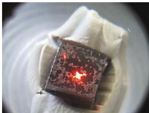
**Figura [5.1]. Zona en la que se realizó el ensayo de rayos X de la pieza de hierro nodular.**
