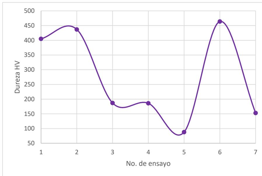
Gráfica [5.6]. Ensayo Vickers. Fundición Centrífuga
