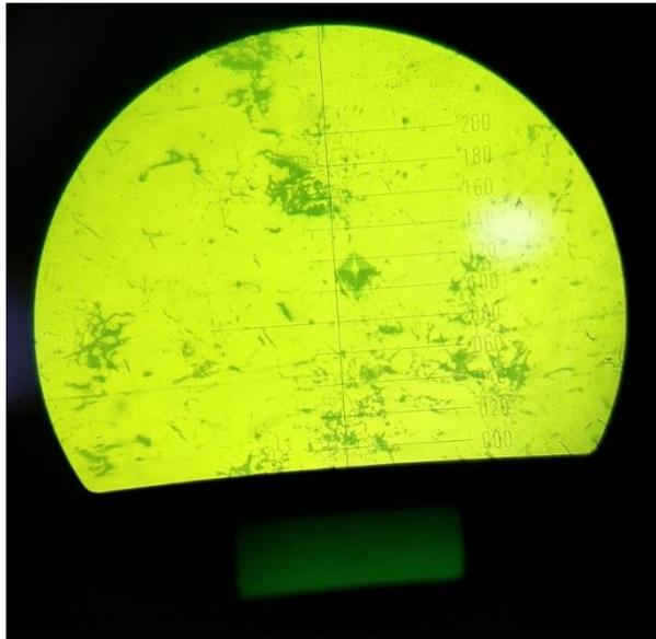
**Figura [5.11]. Ensayo Vickers de la muestra de fundición gris**
