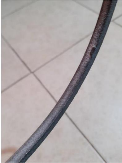
**Figura [4.3] Grosor del anillo de fundición de arena.**
