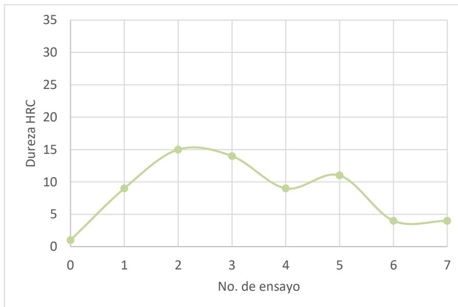
Gráfica [5.2]. Ensayo Rockwell. Fundición gris en molde de arena.
