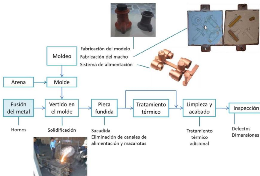
Figura [2.4] Proceso de la fundición de arena. (García. 2016)
