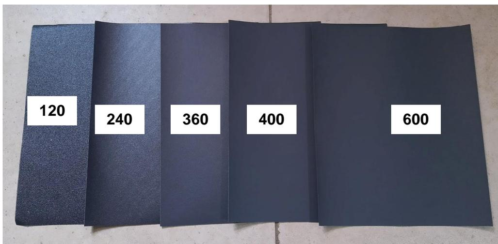
**Figura [4.17] Lijas de agua utilizadas para el desbaste y pulido de las probetas.**
