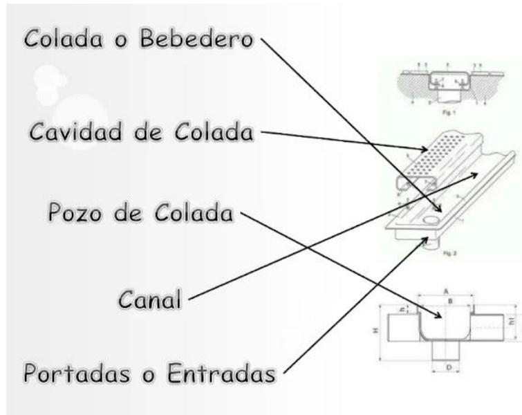
Figura. [1.3] Caracterización de un sistema de colada.
