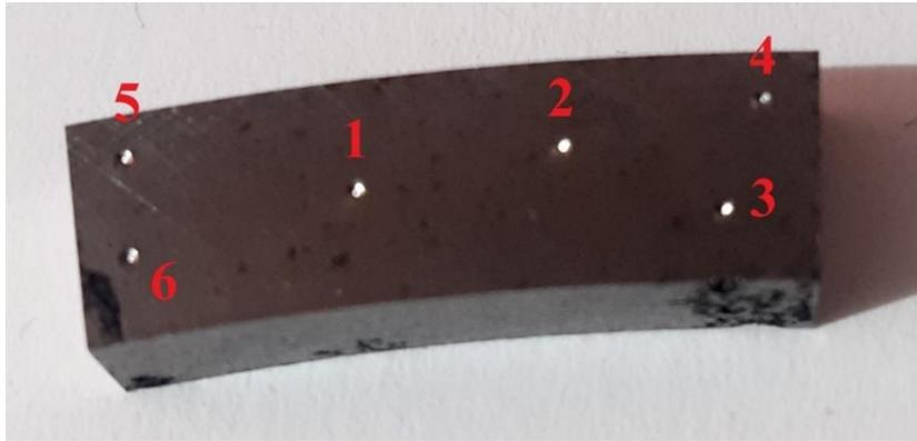
**Figura [5.4]. Pieza ensayada (dureza Rockwell C) de la probeta de fundición nodular.**
