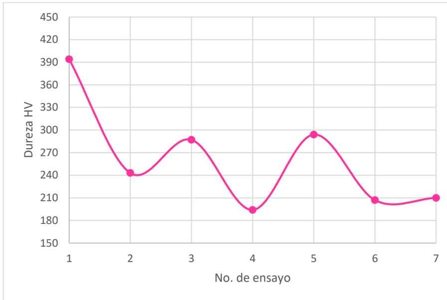
**Gráfica [5.5]. Ensayo Vickers. Fundición gris en molde de arena**
