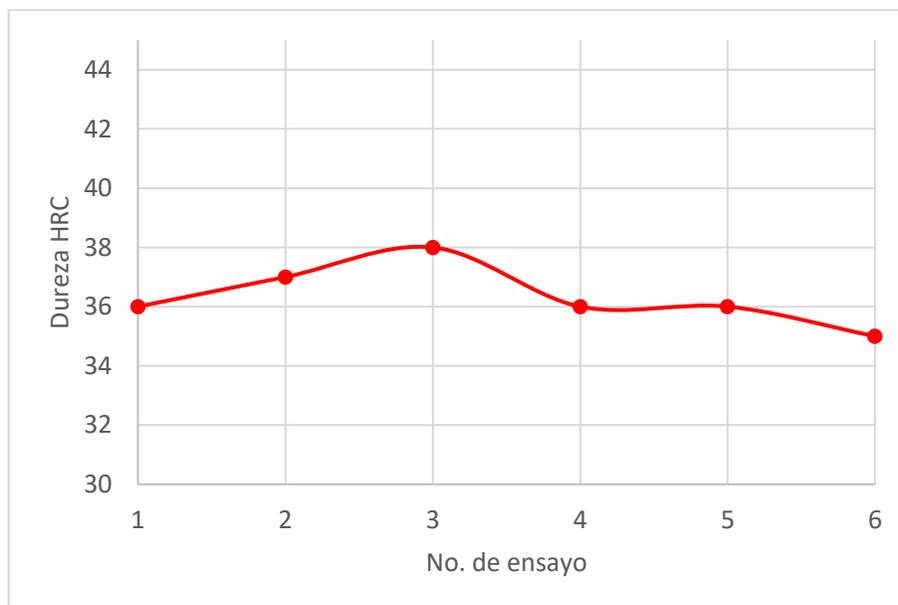
**Gráfica [5.1]. Ensayo Rockwell. Fundición nodular por el proceso de Centrifugación.**
