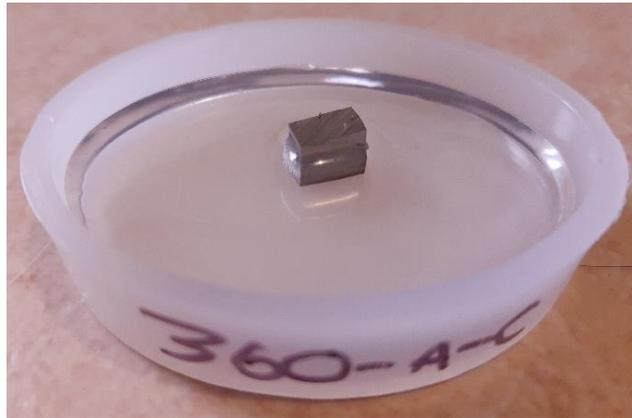
**Figura [4.14] Muestra del anillo obtenido por fundición de arena, dimensión de 0.4 [in].**
