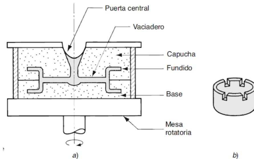
Figura [2.2] Proceso de la fundición centrífuga (a) y el producto obtenido (b). (Groover, 2007)
