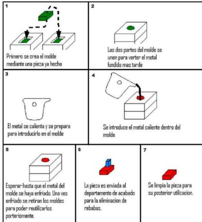
**Figura [1.1] Procedimiento para colada utilizando un molde de arena.**
