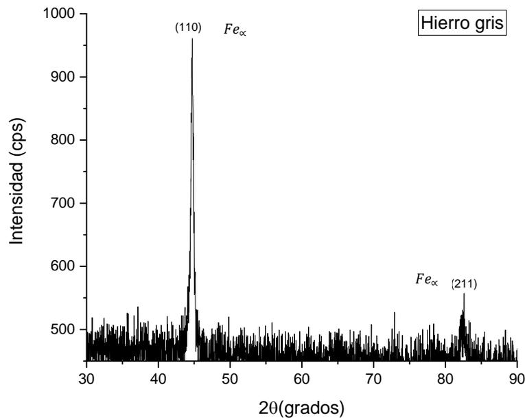
**Difractograma [2]. Patrón de difracción de rayos X sobre la superficie de una pieza de hierro gris**
