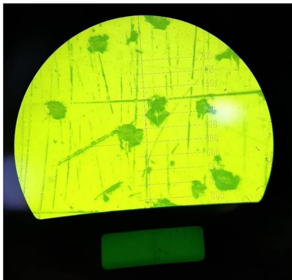
**Figura [5.13] Huella en la fundición nodular.**
