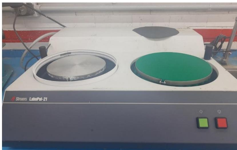
**Figura [4.19] Máquina de lijado mecánico. Se utiliza el disco derecho para la lúmina gris y el disco izquierdo para la lúmina blanca.**
