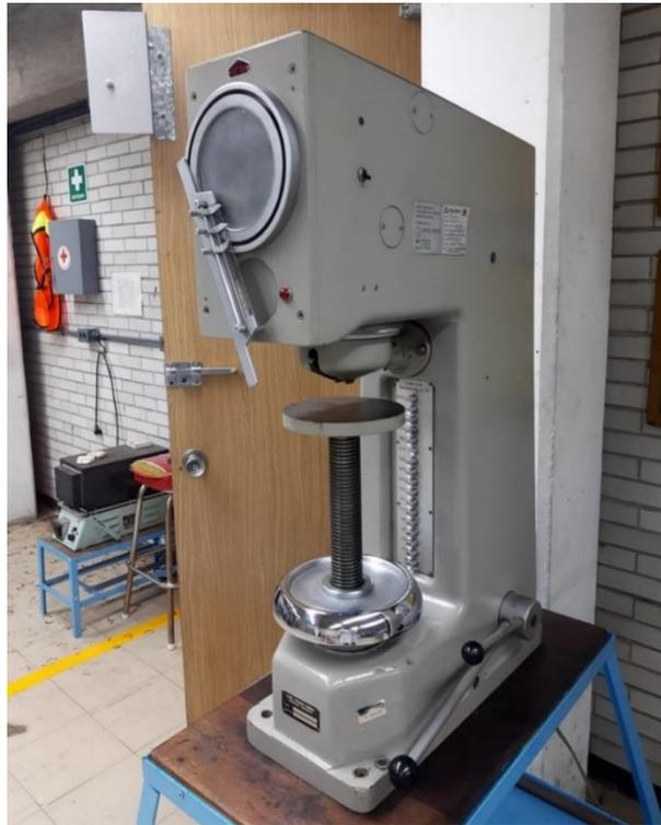
Figura [3.6] Equipo para la obtención de dureza Brinell.
