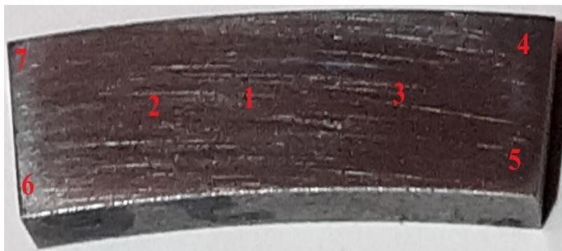
Figura [5.14]. Aproximación gráfica de los puntos donde se realizó en ensayo Vickers en la fundición nodular
