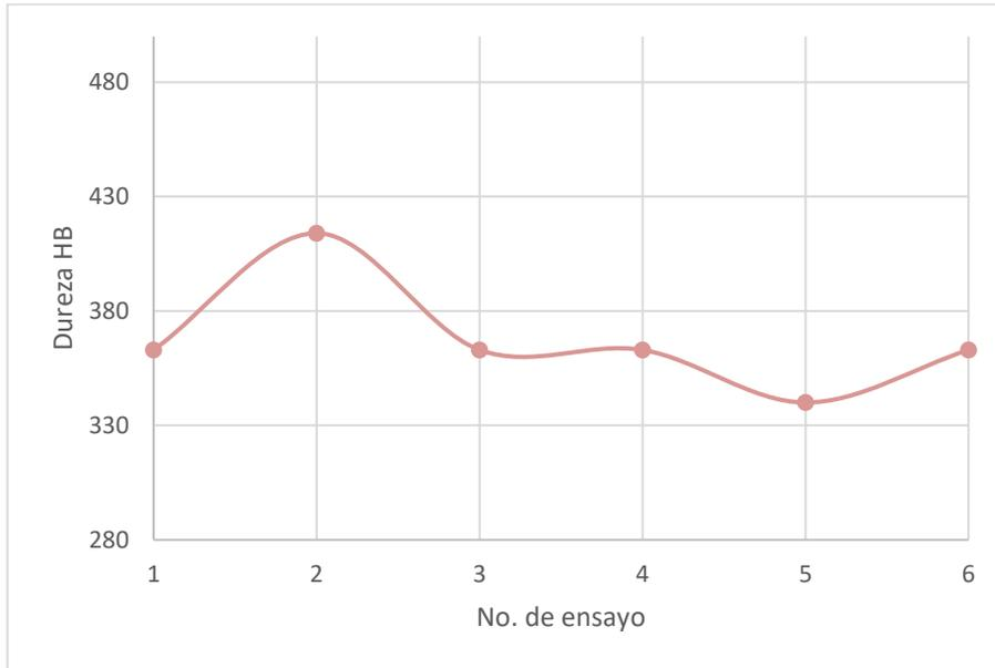
**Gráfica [5.3]. Ensayo Brinell. Fundición Centrífuga**
