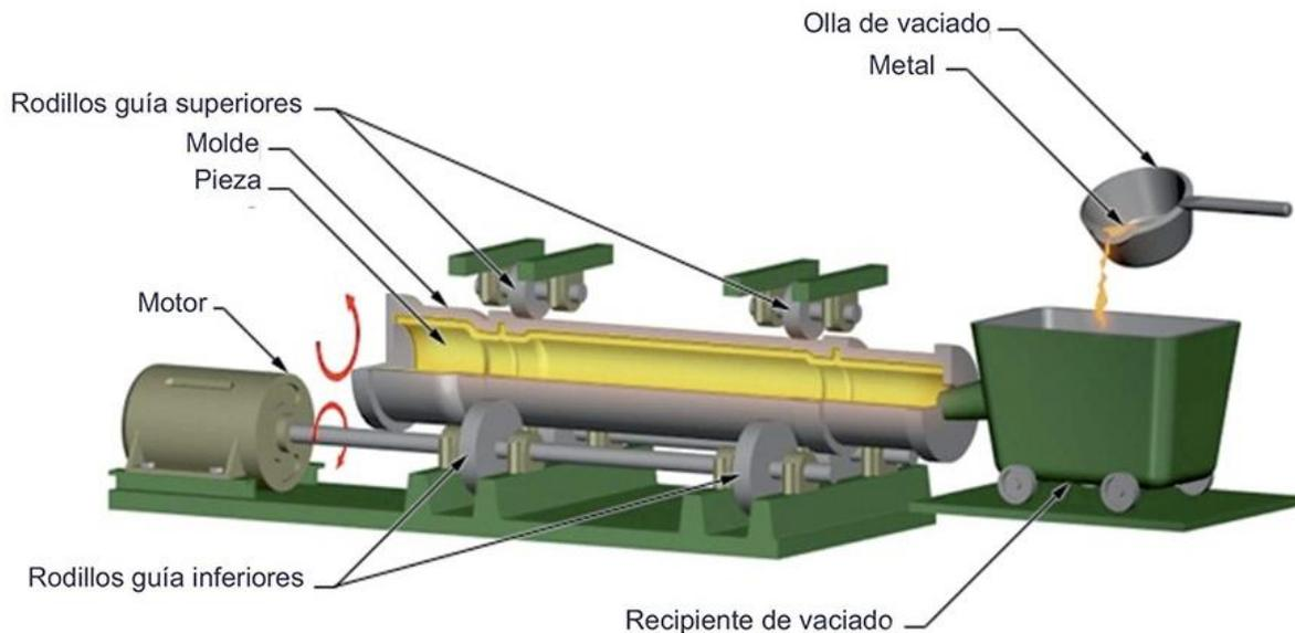
**Figura [2.3] Esquema de un diseño común para una máquina de centrifugado horizontal. <sup>6</sup>**
