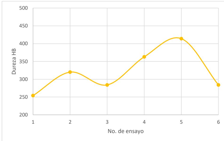
**Gráfica [5.4]. Ensayo Brinell. Fundición gris en molde de arena**
