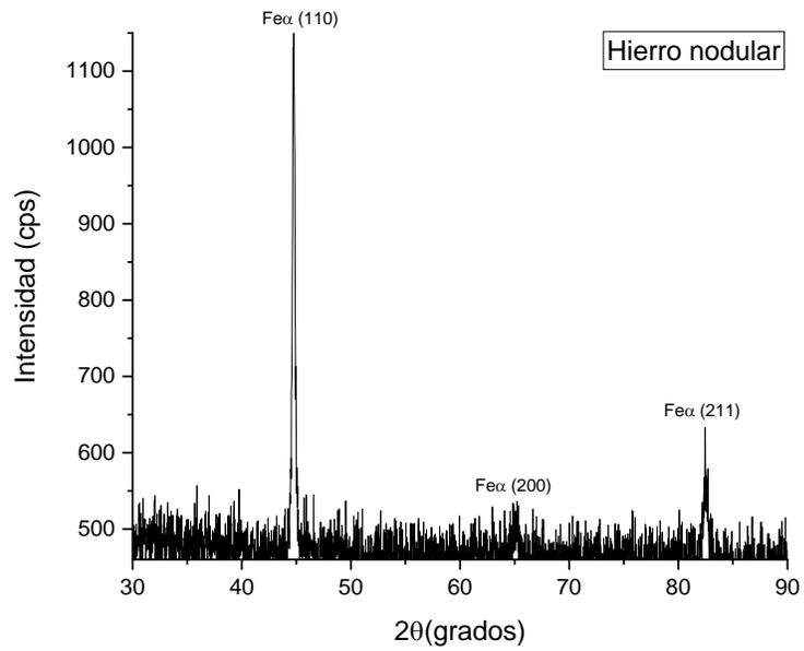
**Difractograma [1]. Patrón de difracción de rayos X sobre la superficie de una pieza de hierro nodular**
