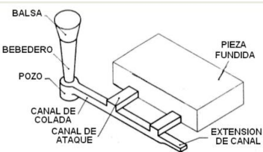
Figura [1.2] Esquema básico de un sistema de colada.
