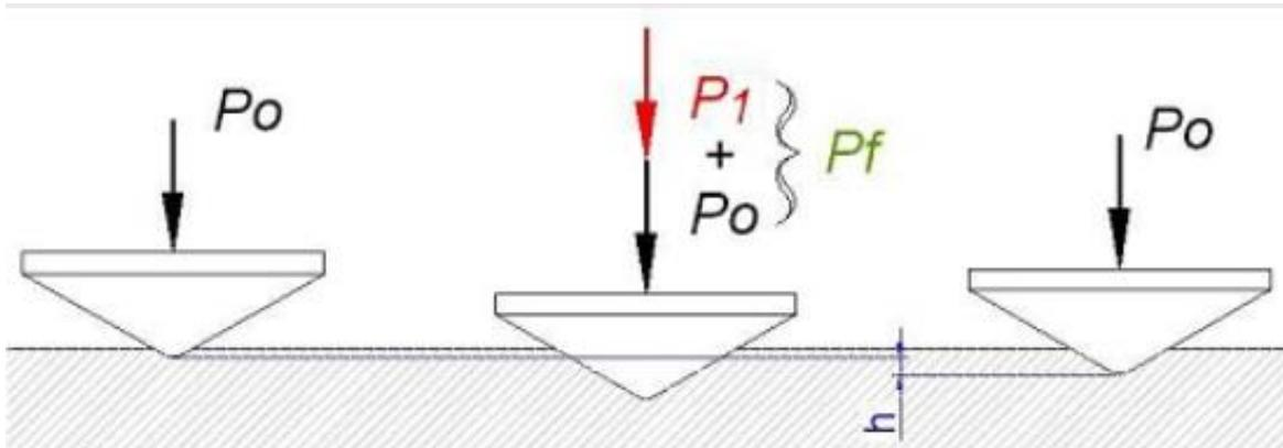
**Figura [3.4] Esquema de aplicación de carga para el ensayo de dureza Rockwell.**
