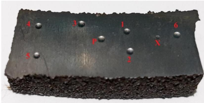
Figura [5.10]. Resultados del ensayo de dureza Brinell para la probeta de fundición gris.
