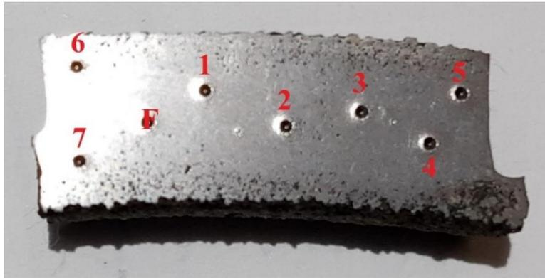
Figura [5.5]. Huellas de los ensayos de dureza Rockwell para la probeta de fundición gris.
