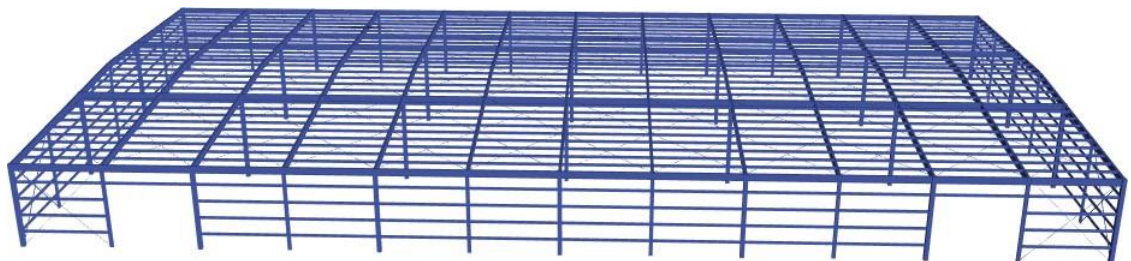
Ilustración 10 Nave industrial estructurada con marcos rígidos contraventeados en ambos sentidos. Vista lateral
