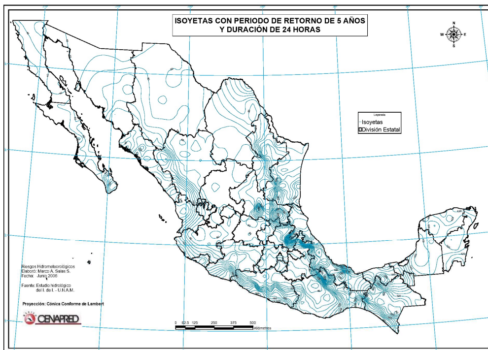
Mapa 5 Isoyetas con periodo de retorno de 5 años y duración de 24 horas. (CENAPRED, ACUERDO por el que se emite la guía de contenido mínimo para la elaboración del Atlas Nacional de Riesgos., 2016)
