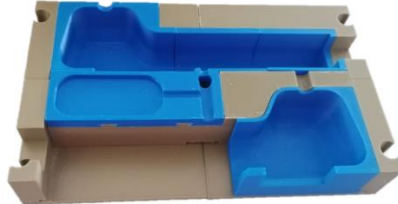
Figura 66. Prototipo modular de las placas de cavidades y corazones en proceso de ensamble.
