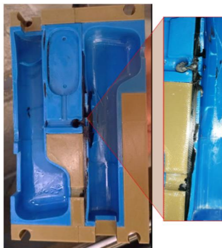
Figura 78. Placa de cavidad del molde.
