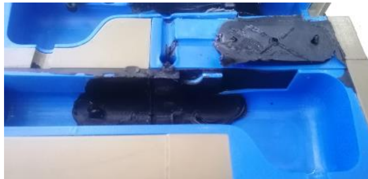
Figura 84. Canal de alimentación atascado.
